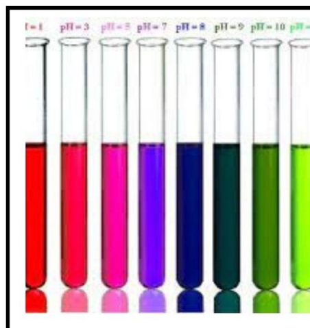
Figura 08: Soluções com extrato de repolho roxo funcionando como indicador de pH. Fonte: Manual da química.
