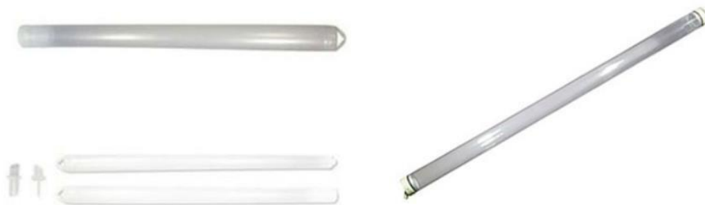
Figura 10- Bailer para amostragem de água subterrânea.
