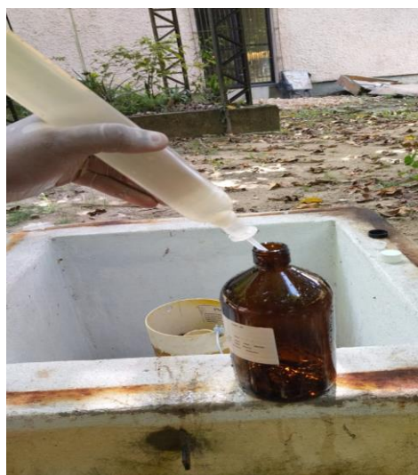
Figura 36- Coleta da amostra em vidro (medições com o bailer).
