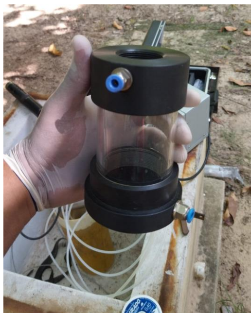
Figura 21- Montagem da célula de fluxo.
