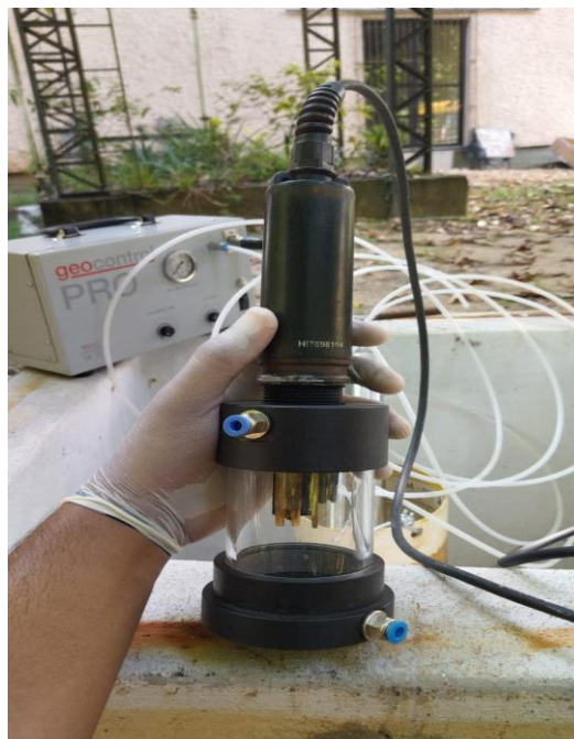
Figura 25- Sonda Multiparâmetros com encaixe na célula de fluxo.
