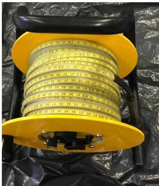
Figura 14- Medidor de nível de água.
