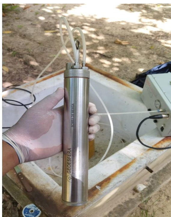
Figura 18- Montagem da Bomba de bexiga.
