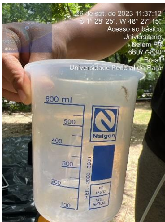
Figura 23- Becker de plástico graduado para medição de vazão.
