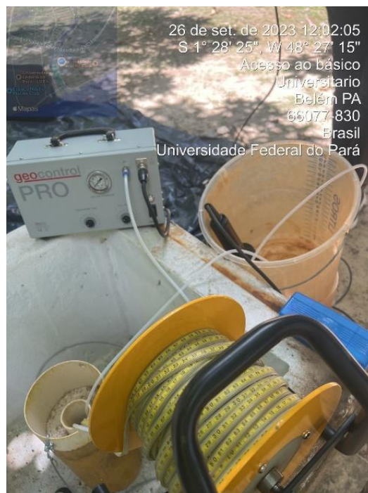
Figura 23- Becker de plástico graduado para medição de vazão.
