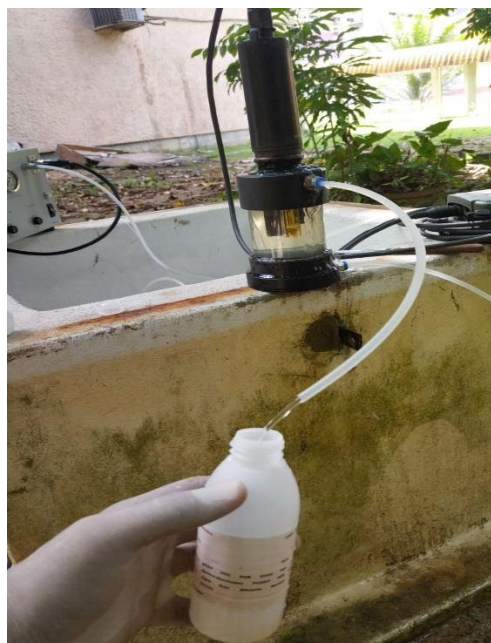
Figura 28- Transferências para os frascos de Polietileno (medição em baixa vazão).
