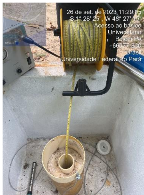
Figura 19- Início da medição de nível.
