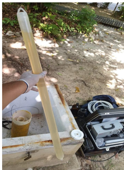
Figura 33- Coleta da amostra utilizando o bailer.
