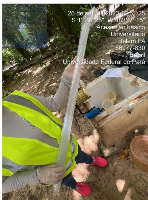
Figura 31- Bailer descartável e lacrado para ser utilizado nas medições.
