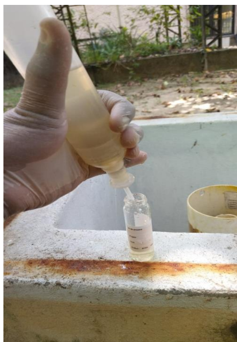
Figura 35- Coleta da amostra em polipropileno (medições com o bailer) .
