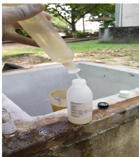
Figura 37- Coleta da amostra em frasco polietileno (medição em baixa vazão).
