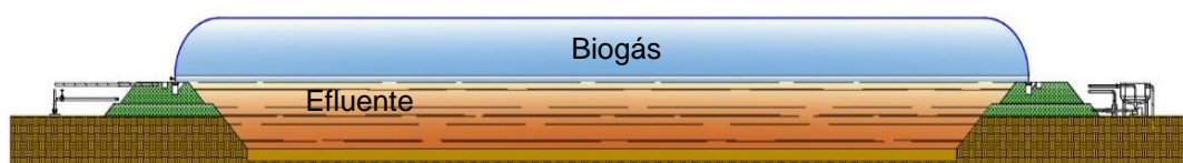
Figura 12 – Desenho esquemático da lagoa coberta, corte longitudinal
