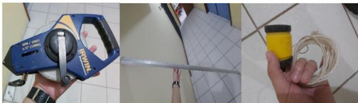
Figura 5 - Materiais utilizados no levantamento batimétrico
