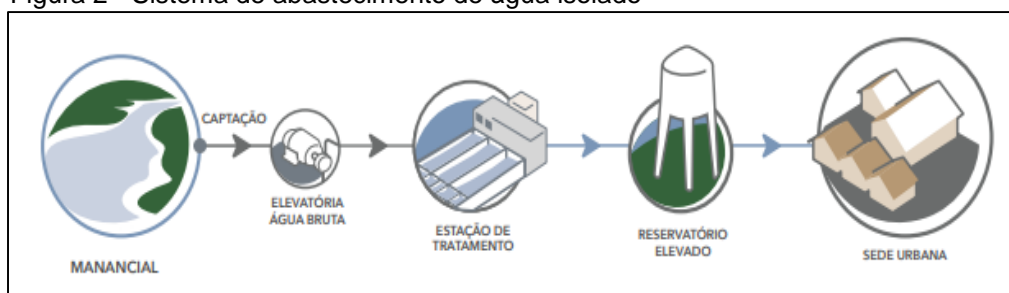
Figura 2 - Sistema de abastecimento de água isolado
