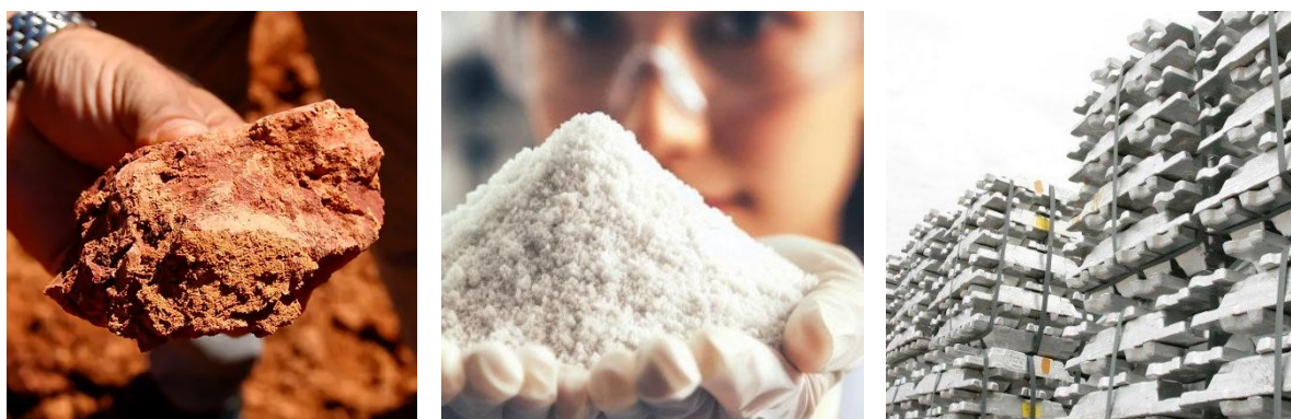
Figura 11 - As três etapas do alumínio: Bauxita, à esquerda, Alumina em pó (Óxido de Alumínio) ao centro e lingotes de Alumínio (alumínio primário) à direita
