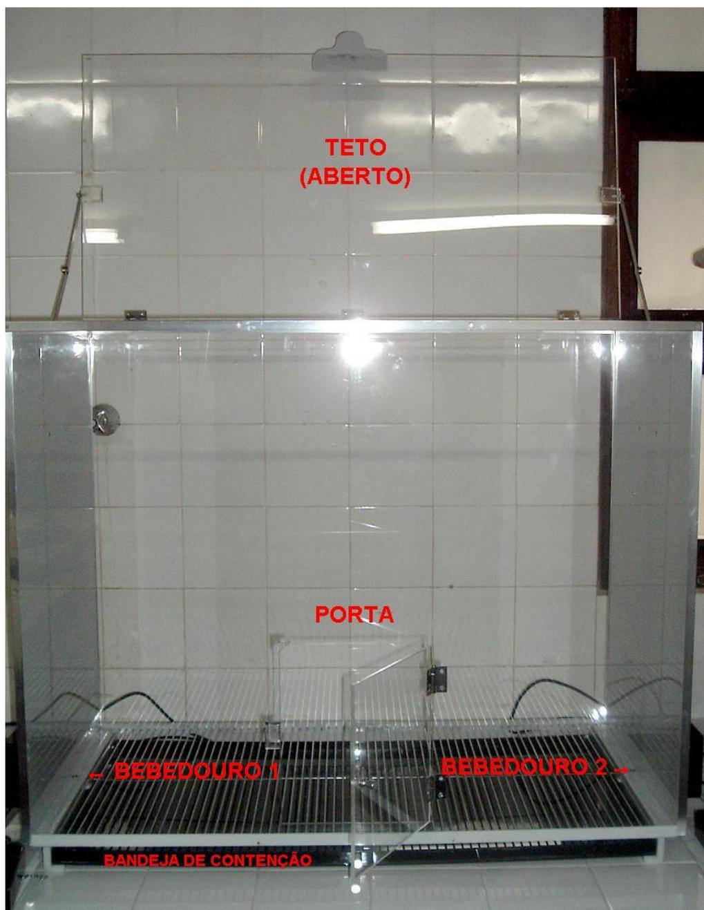
Figura 3: Fotografia frontal da Câmara de Insight. Na figura encontram-se identificados os bebedouros, a porta convencional, o teto aberto e a bandeja de contenção de dejetos.
