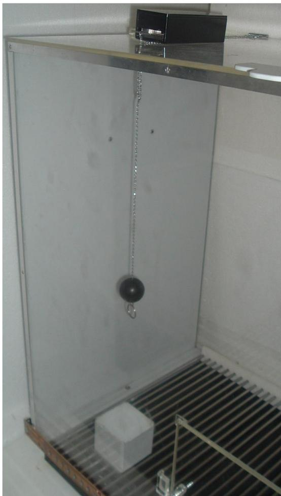
**Figura 4:** Fotografia lateral da Câmara de Insight, onde pode ser vista a corrente presa à barra móvel, suspensa sobre a caixa de papelão.
