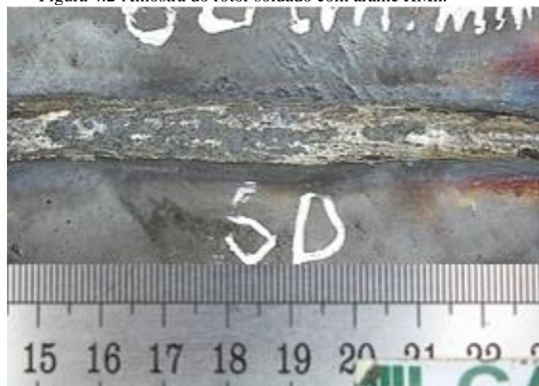
Figura 4.2-Amostra do rotor soldado com arame HMn.
