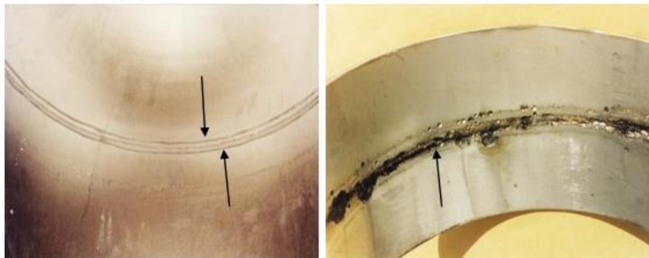
Figura 2.12- Corrosão em torno do cordão de solda de um aço inoxidável.
