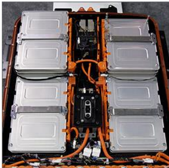
Figura 4 - Baterias de íons de lítio utilizadas na maioria dos veículos elétricos.
