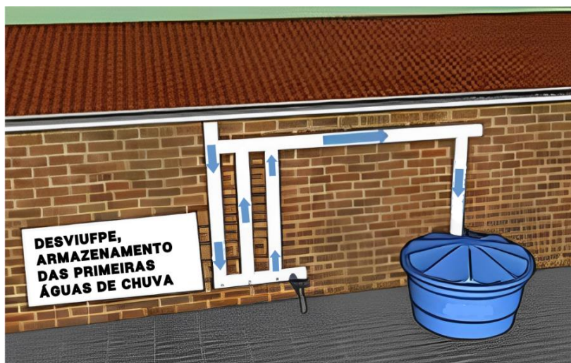
Figura 11 - Dispositivo de desvio das primeiras águas de chuva DesviUFPE.
