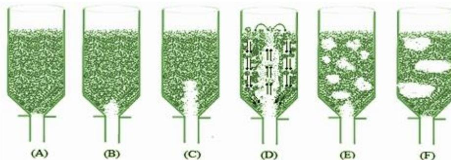
(A) Leito fixo; (B) Formação de uma pequena cavidade; (C) desenvolvimento do jorro interno; (D) jorro externo; (E) jorro borbulhante e (F) *slugging*.
