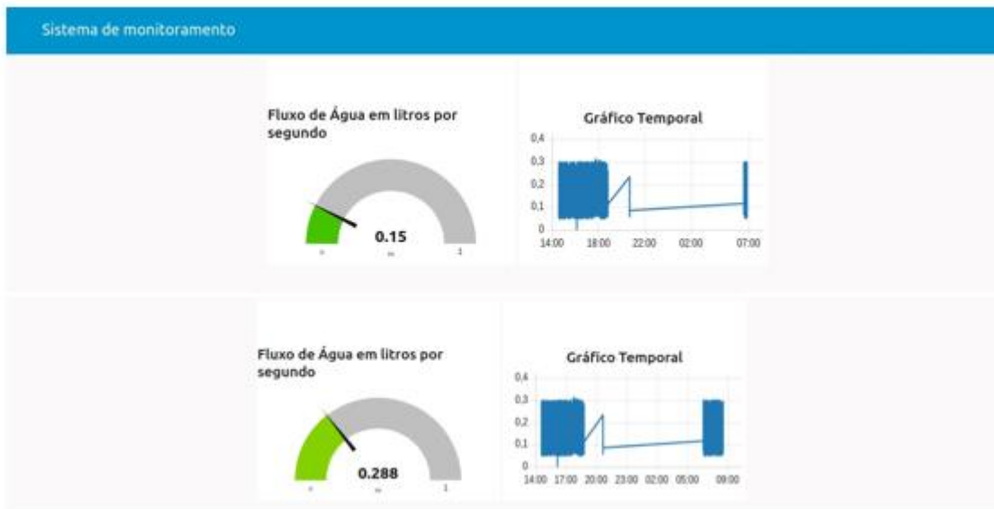
Figura 16 – Dashboard do consumo de água e vazão de água ao longo do dia
