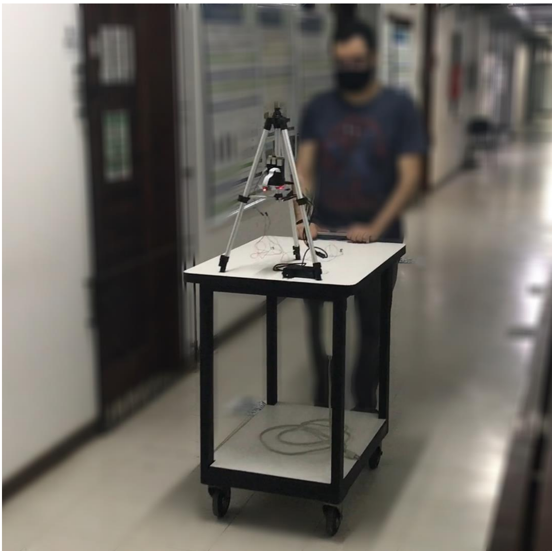
Figura 35. Teste de funcionamento do sistema sem tela e ligado à bateria, à velocidade de caminhar de aproximadamente 0,4 m/s (1,44 km/h). Imagem registrada e editada pelo autor.
