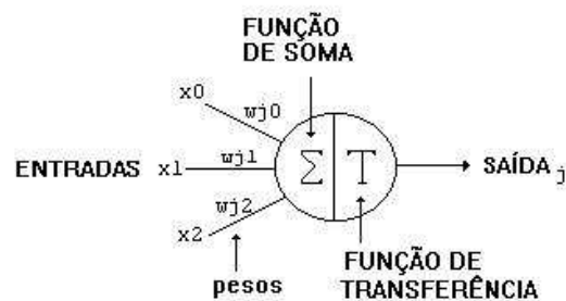
Figura 2.2: Estrutura de um neurônio artificial.
