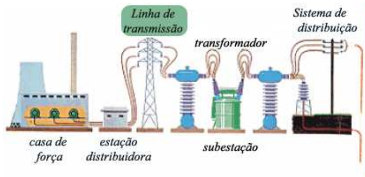
Figura 1.1: Esquema de transmissão de energia elétrica [1] .
