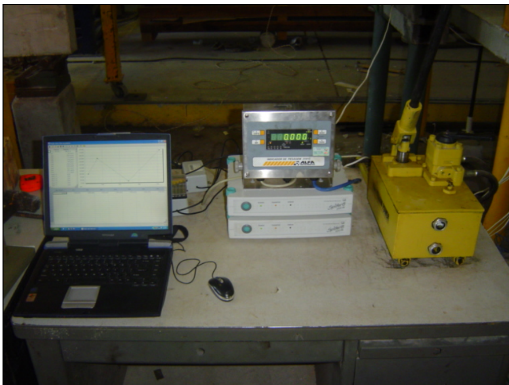
Figura 3.4 – Esquema de aquisição de dados
