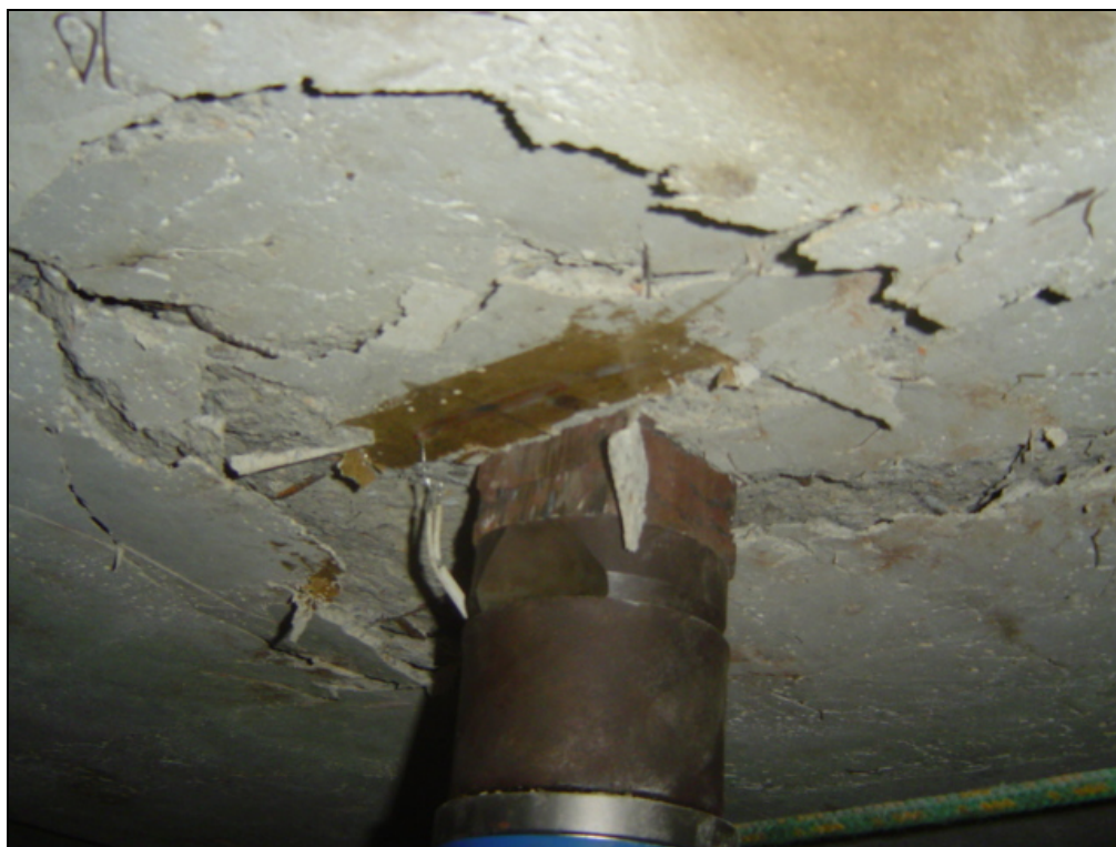
Figura 4.1 – Perímetro crítico afastado das faces do pilar
