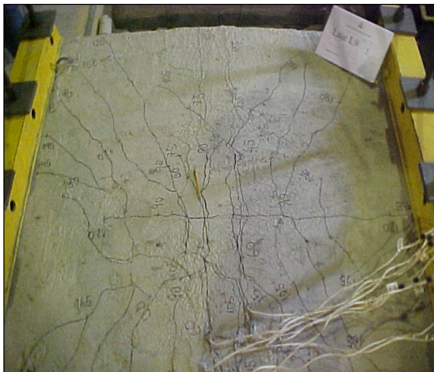
Figura 4.48 – Mapa de fissuração da laje L9
