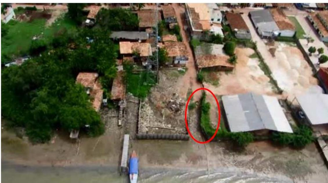
Figura 10: Imagem aérea do local de embarque e desembarque de crianças, com detalhe do “embarrigamento” do talude artificial.
