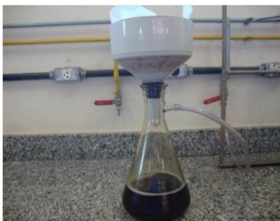
Figura 16- Filtração à vácuo para obtenção da solução ETOH
