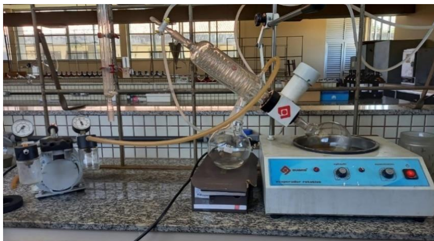
Figura 15- Solução evaporada em evaporador rotativo
