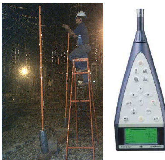
Figura 5.7. Medição do LAeq na face posterior (à esquerda) em malha acústica localizada a 1,95 m do reator e medidor utilizado (à direita).
