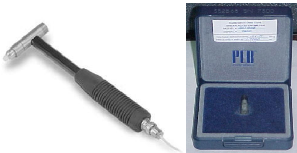
Figura 6.2. Martelo de impacto com célula de carga acoplada (à esquerda) e acelerômetro uniaxial (à direita) ambos do fabricante PCB e com ICP (circuito pré-amplificador de sinal).
