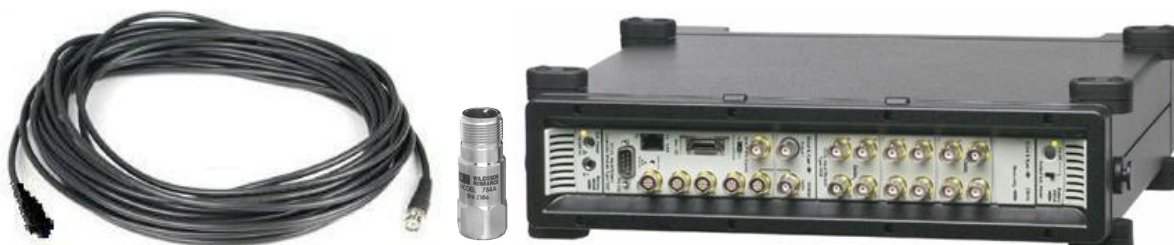
Figura 5.4. Cabo coaxial (à esquerda), acelerômetro uniaxial (centro), e analisador PULSE, da B&K (à direita) utilizados nas medições de aceleração global das chaparias externas do reator.
