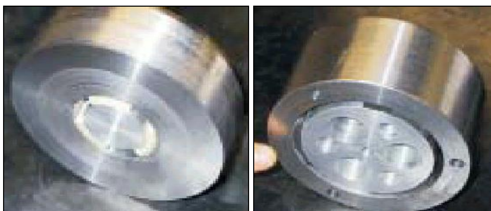
Figura 3.11. Absorvedor sintonizado em 120 (à esquerda) e 240 Hz (à direita) (FILLIPIN et al, 2003b).
