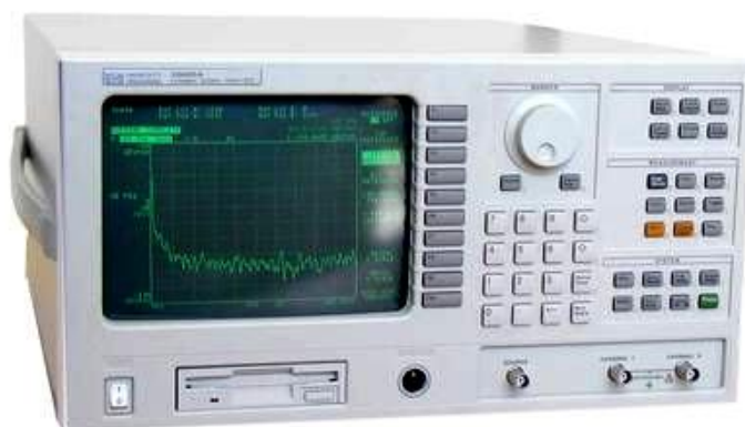
Figura 5.19. Analisador dinâmico de sinais HP 35665A utilizado na coleta dos dados experimentais.
