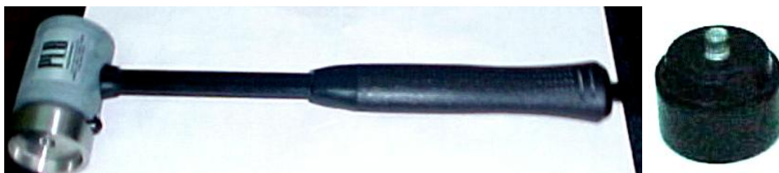
Figura 5.18. Martelo de impacto utilizado na análise modal do reator e ponta de borracha.
