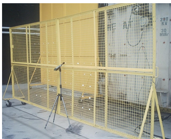
Figura 5.14. Malha acústica a 1,70 m da face posterior (traseira) do reator.
