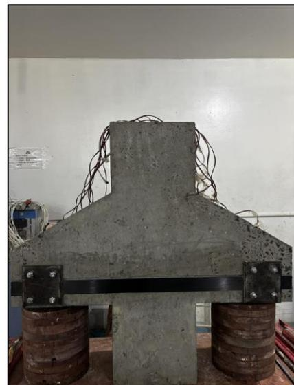
b) Consolo reforçado com ancoragem híbrida
