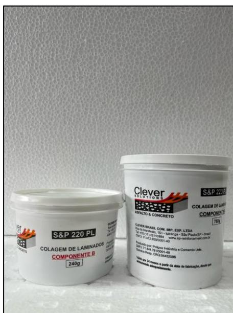
Figura 3.16– Resina epóxi utilizada.
