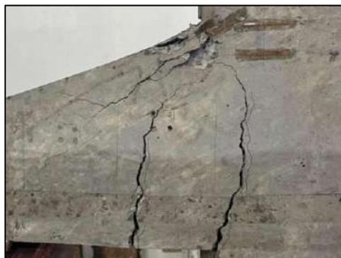
d) Rachadura de flexão
