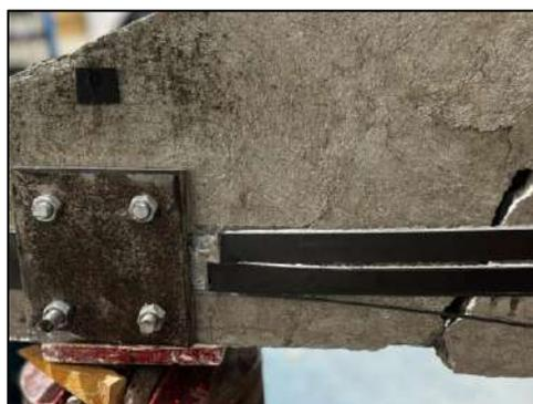
d) Ruptura longitudinal do laminado
