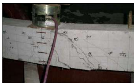
a) Ruptura por cisalhamento (BM3)
