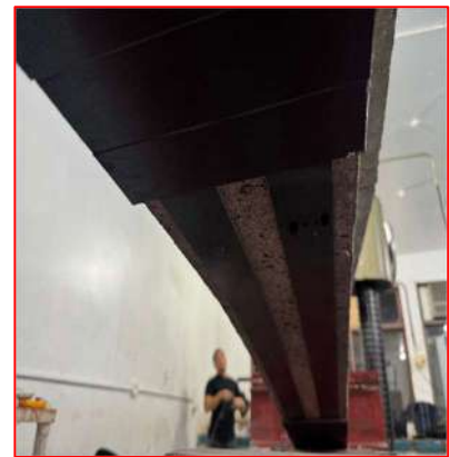
d) Det. 3 – Fibra colada
