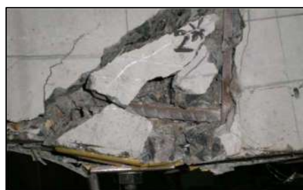
b) Ruptura por cisalhamento (BM5)
