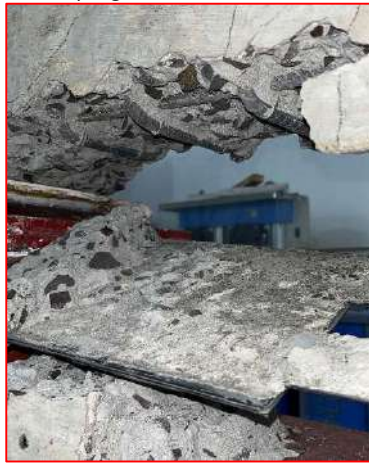
c) Det. 2 – Delaminação CC e destacamento do concreto
