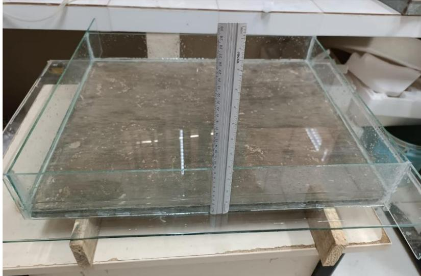
**Figura 3.18: Instrumentalização do ensaio de permeabilidade pelo método da caixa.**
