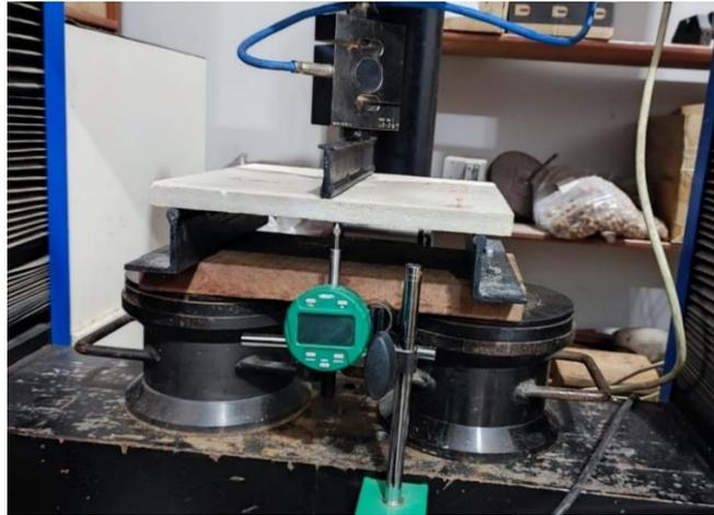
Figura 3.15: Instrumentalização do ensaio de resistência a flexão e módulo de elasticidade. Fonte: Autor
