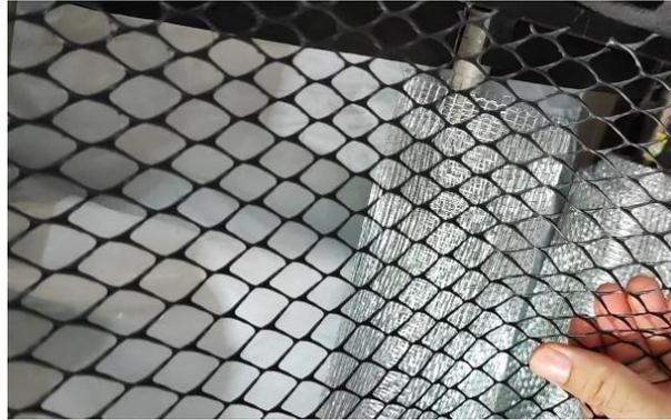
**Figura 3.6: Tela de polietileno de alta densidade. Fonte: Autor**
