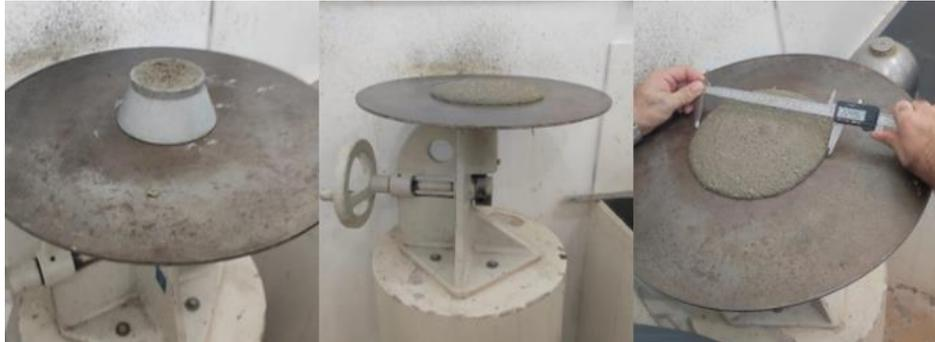
**Figura 3.10: Ensaio Índice de consistência das argamassas. Fonte: Autor**
