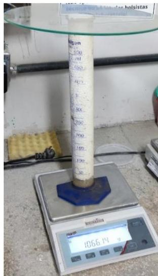
**Figura 3.5: Conjunto de ensaio de densidade das pérolas de EPS. Fonte: Autor**
