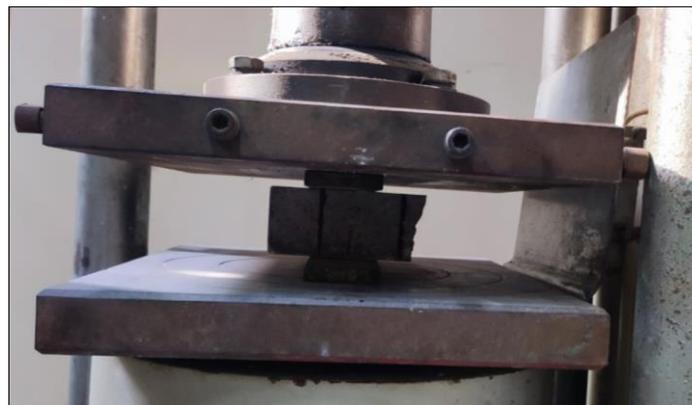
**Figura 3.13: Rompimento de CP's ensaio de resistência a compressão. Fonte: Autor**
