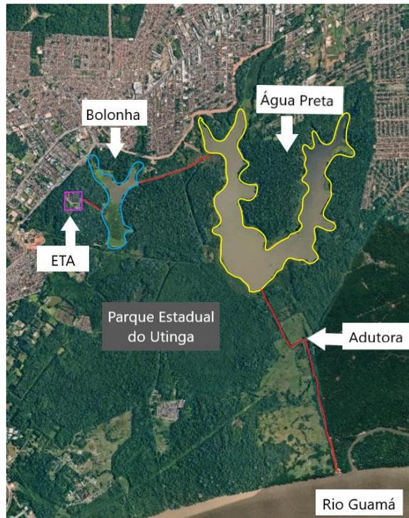
Figura 1 - Sistema de captação e distribuição de rio Guamá. Fonte: Adaptada-Google Earth (2024).
