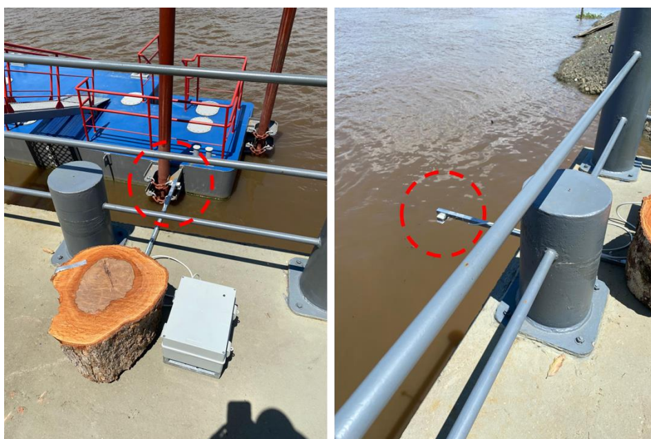
Figura 15 – Teste do sensor de nível HC-SR04 no trapiche da Universidade Federal do Pará. Fonte: Autor.
