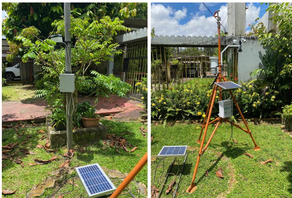
Figura 16 – Teste do protótipo de monitoramento contínuo (PMC) em área arborizada. PMC à esquerda e Estação de referência (EMC) à direita. Fonte: Autor.
