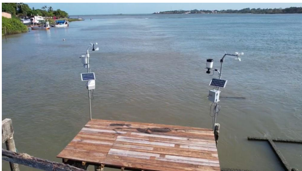
Figura 19 – Estação meteorológica de referência (EMC) à esquerda e o protótipo de monitoramento contínuo (PMC) à direita. Fonte: Autor.
