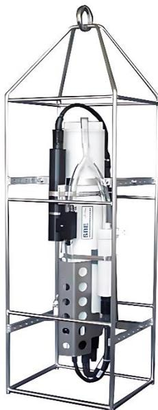
Figura 9 – CTD SBE 19plus V2 SeaCAT em operação de perfilamento. Equipamento mede condutividade (precisão  $\pm 0,0005$  S/m), temperatura ( $\pm 0,005^\circ\text{C}$ ) e pressão (até 6000 m de profundidade, com precisão de  $\pm 0,1\%$  do fundo de escala).
