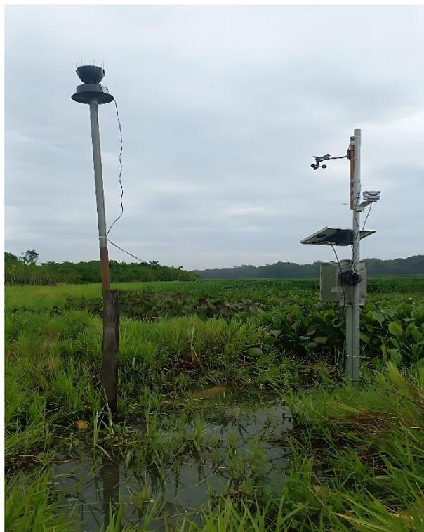
Figura 14 – Estação meteolimnométrica automática da empresa AG Solve Monitoramento Ambiental que está localizada as margens do lago Água Preta
