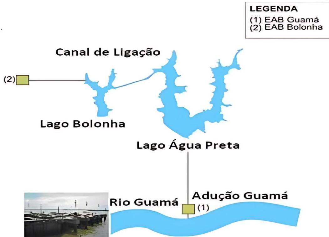
Figura 3 – Sistema de adução e captação de água dos lagos. Fonte: Pereira 2004 (adaptado)
