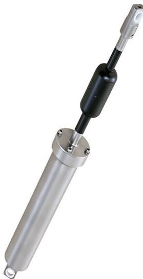
**Figura 13** – O Infinity EM é um registrador de medidor de corrente eletromagnética. O instrumento fornece medições de corrente 2-D de alta precisão, mesmo em condições de baixa dispersão, onde ADVs (Velocímetro Doppler Acústico) não funcionam bem. A faixa de medição vai de 0 a  $\pm 500$  cm s<sup>-1</sup>. O design do instrumento é compacto (1,0 kg no ar) e permite medições de velocidade de corrente virtualmente em qualquer lugar.
