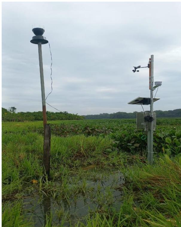
Figura 2 – Estação meteorolímométrica automática da AG Solve instalada as margens do lago Água Preta.
