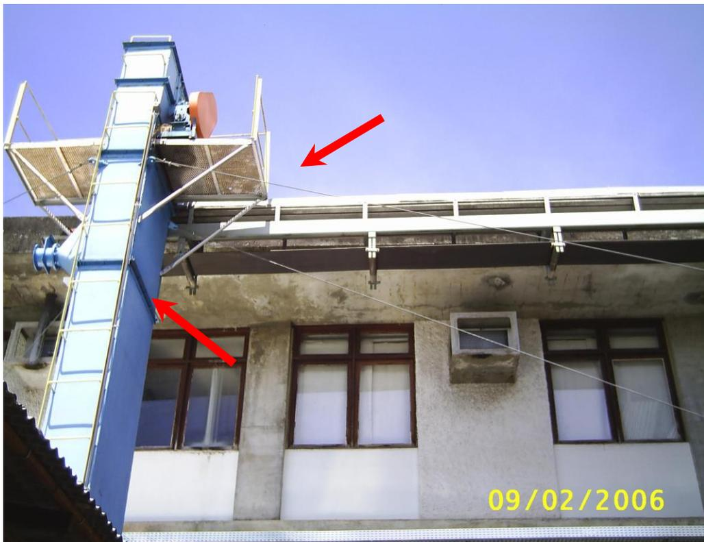
Fotografia 1: Elevador caneca com esteira transportadora para os Silos.
