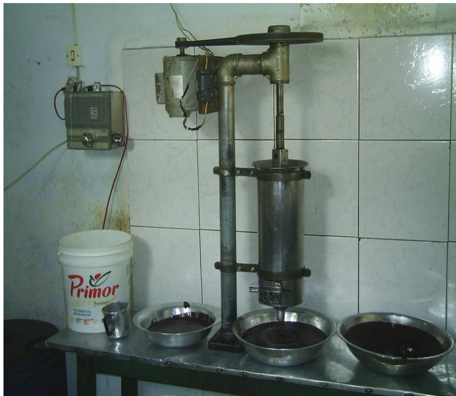
Fotografia 9: Máquina de despulpamento do fruto açai (Belém-Pará).
