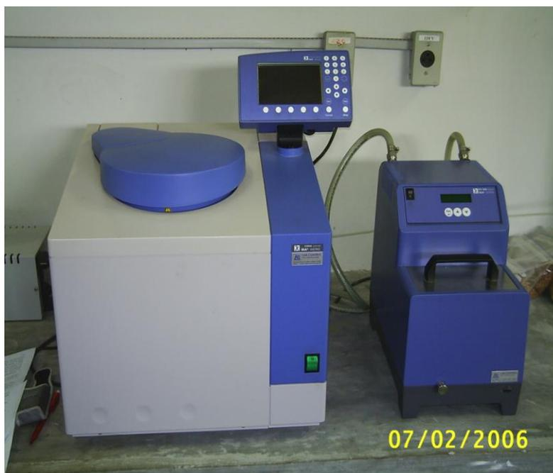
Fotografia 26: Bomba Calorimétrica Digital
