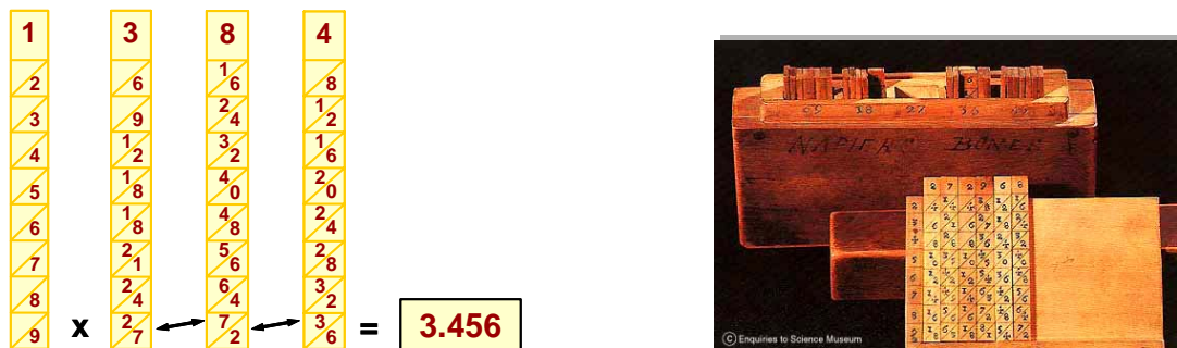
Figura 2: Simulação da multiplicação de 9 por 384 com Bastões de Napier
