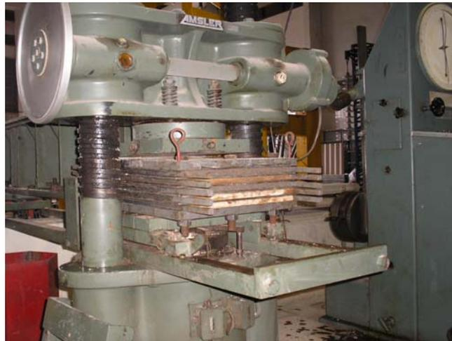
FIGURA 3.11 – Aplicação de pressão para fixação dos parafusos no molde
