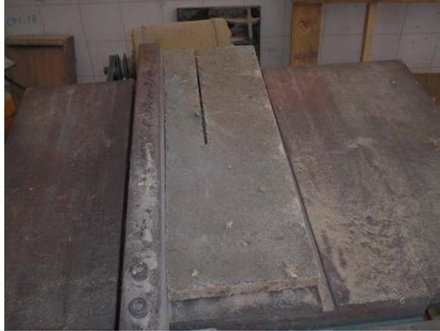
FIGURA 3.13 - Corte dos corpos-de-prova em serra circular
