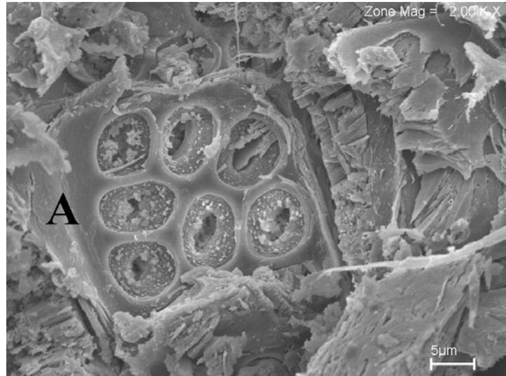
Figura 4.32 – Chapa de cimento-madeira com resíduos de Quaruba.
