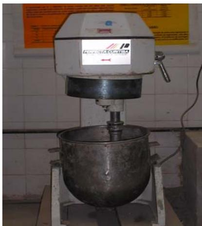
FIGURA 3.7 - Misturador mecânico
