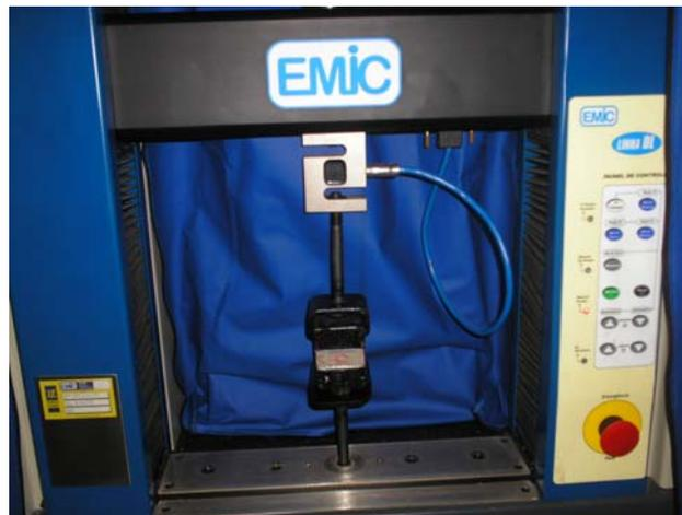
FIGURA 3.18 - Dispositivo para o ensaio de tração perpendicular
