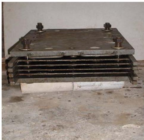
FIGURA 3.9 – Molde metálico para manufatura de chapas cimento-madeira
