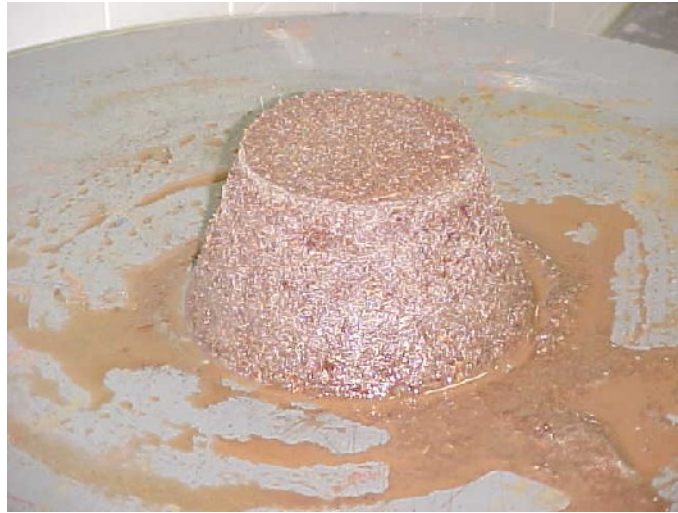
Figura 28 – Exudação excessiva por falta de finos
