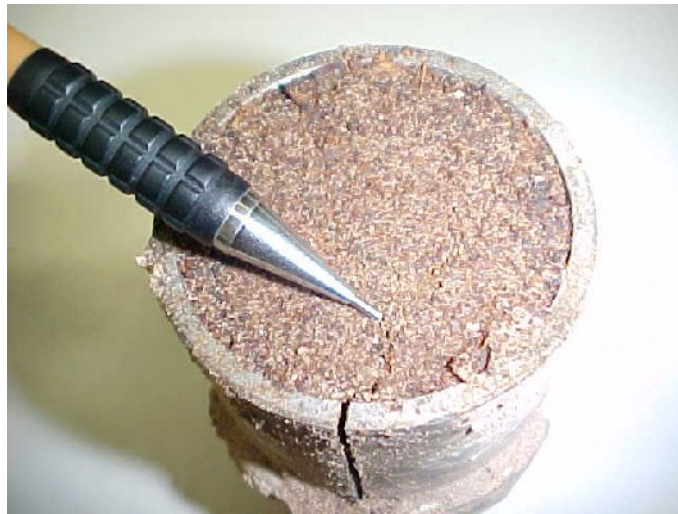
Figura 34 – Fissuras durante a desmoldagem
