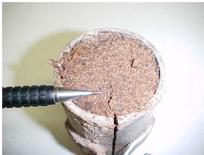
Figura 21 – Fissuras durante a desmoldagem.
