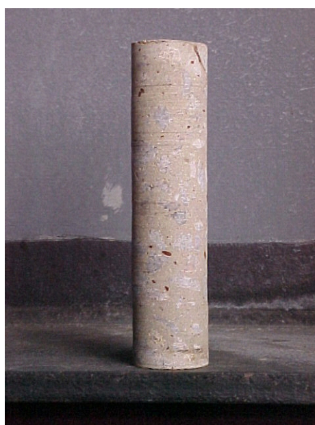
FIGURA 3.15 – Testemunho de concreto da parede
