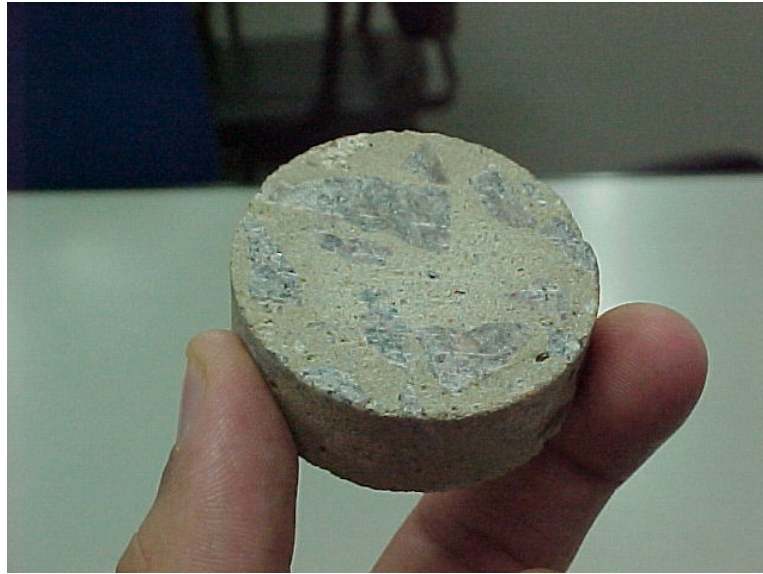
FIGURA 3.16 – Pastilha preparada com dimensão de 50mm de diâmetro por 20mm de espessura.
