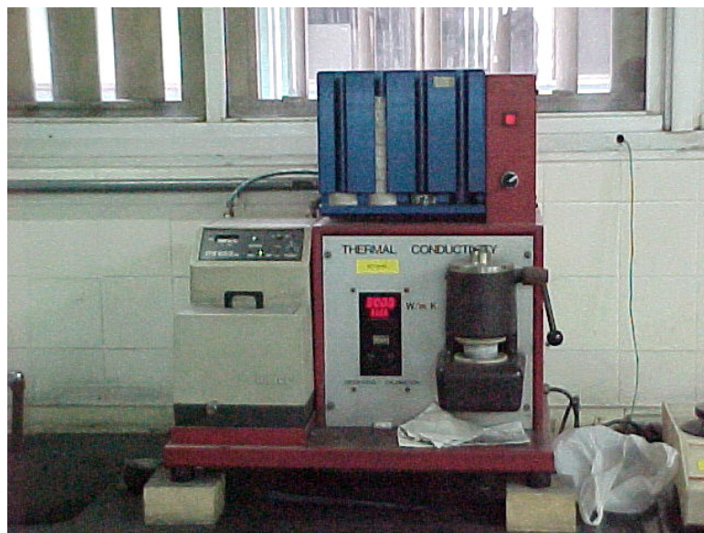
FIGURA 3.17 – Equipamento para medição da condutividade térmica do material
