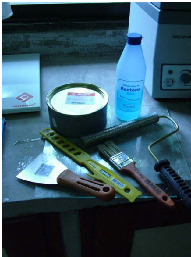
FIGURA 50 – Alguns materiais utilizados: acetona, cera de carnaúba, rolo com ranhuras, trincha, misturador plástico, espátula e vidro temperado.
