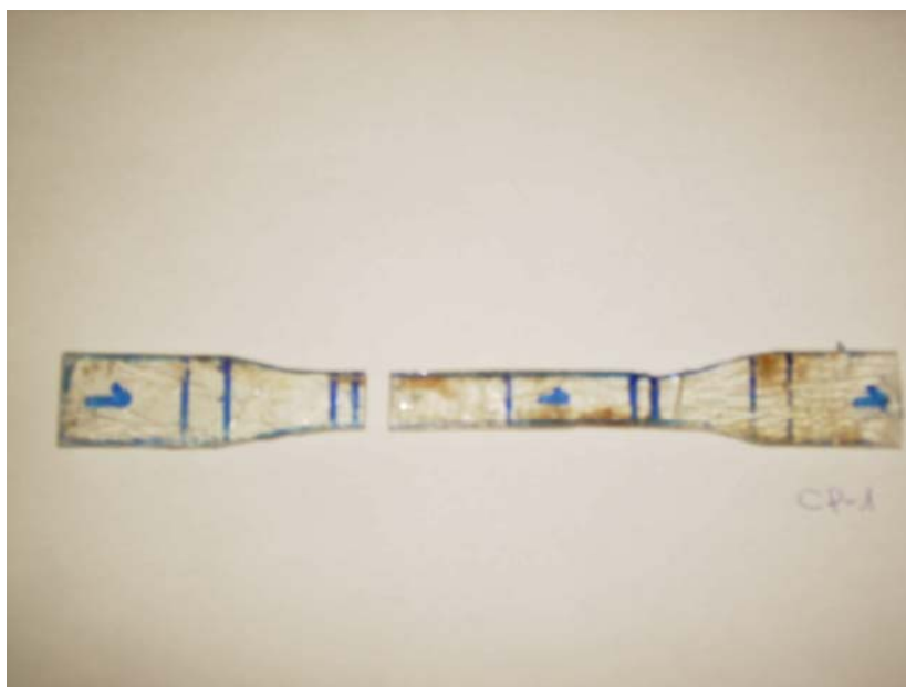
FIGURA 82 – Corpo de prova n°1 da matriz de poliéster após ensaio de tração: partiu em duas partes separadas no limite do extensômetro.
