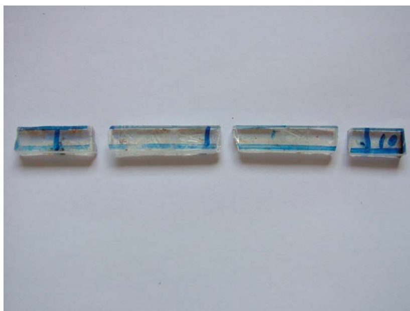
FIGURA 99 – Corpo de prova nº10 da matriz de poliéster após ensaio de flexão: quebra no meio e nos apoios, caracterizando um material frágil.
