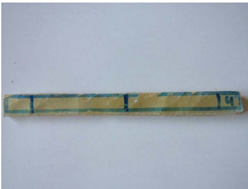
FIGURA 100 – Corpo de prova nº2 da matriz híbrida após ensaio de flexão: devido a lâmina interna de poliuretana o corpo de prova apresentou apenas trincas nas lâminas de poliéster.
