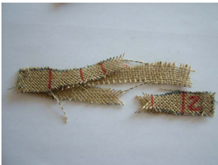
FIGURA 86 – Corpo de prova nº 2 do reforço: essa sobreposição foi efetiva para melhorar o módulo de elasticidade do reforço.
