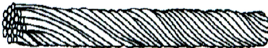
FIGURA 19 – Filamentos contínuos, unidos e torcidos para constituir o fio torcido. Fonte: MEIRELLES, 2004, p. 34.
