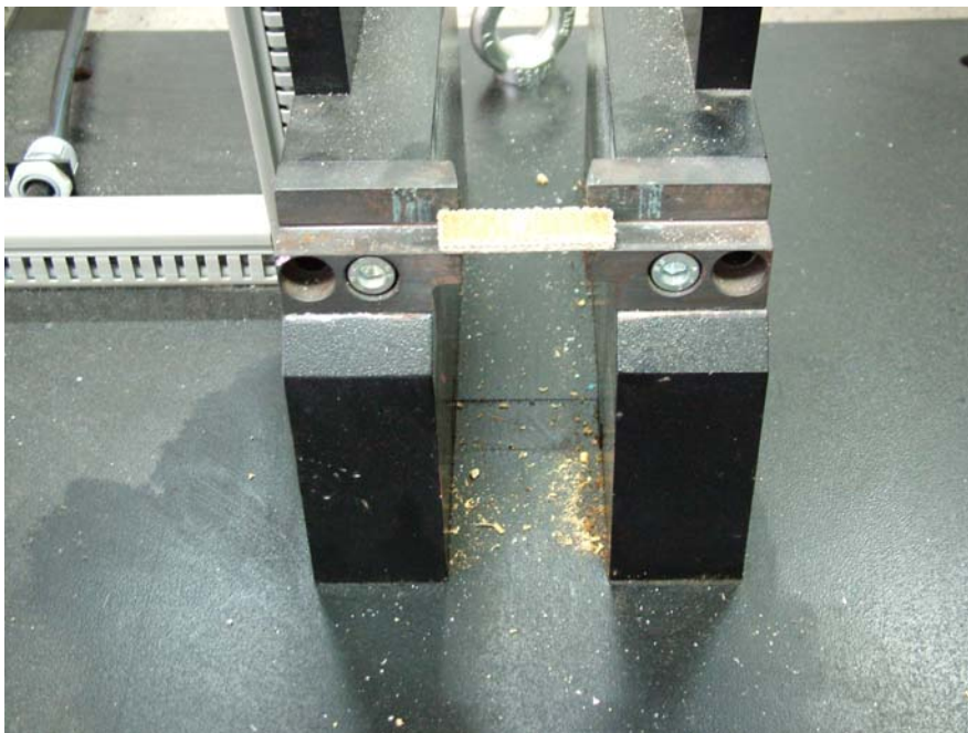
FIGURA 107 – Corpo de prova do compósito sendo submetido ao ensaio de impacto Charpy paralelo ao plano do laminado.
