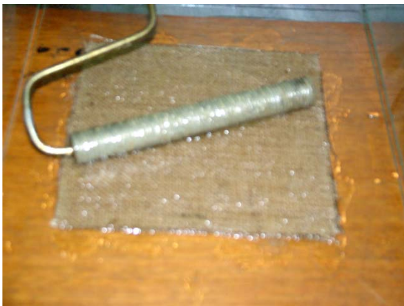
Figura 70 – Espalhamento da resina de poliéster com rolo para melhorar a molhabilidade do tecido.
