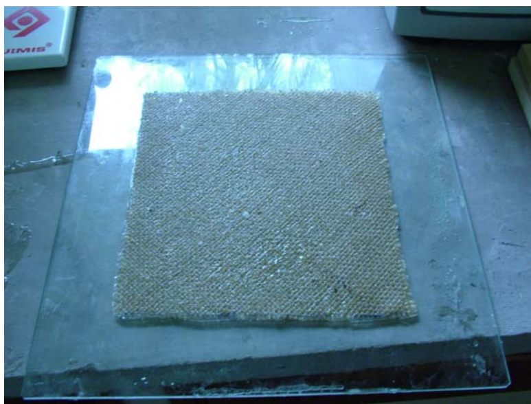
FIGURA 71 – Lâmina de tecido de juta a 45° com a resina de poliéster.
