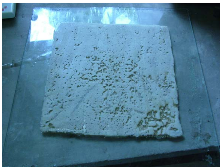
FIGURA 68 – Lâmina de tecido de juta a 90° com a resina de óleo de mamona.
