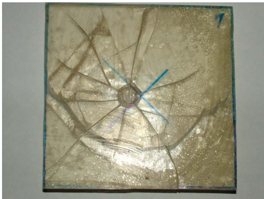
FIGURA 114 – Corpo de prova de matriz híbrida: trincas primárias (radiais) provocadas pela queda do dardo sobre a 1ª camada de poliéster e trincas secundárias (circulares) provocadas pela elasticidade da camada interna de poliuretano.
