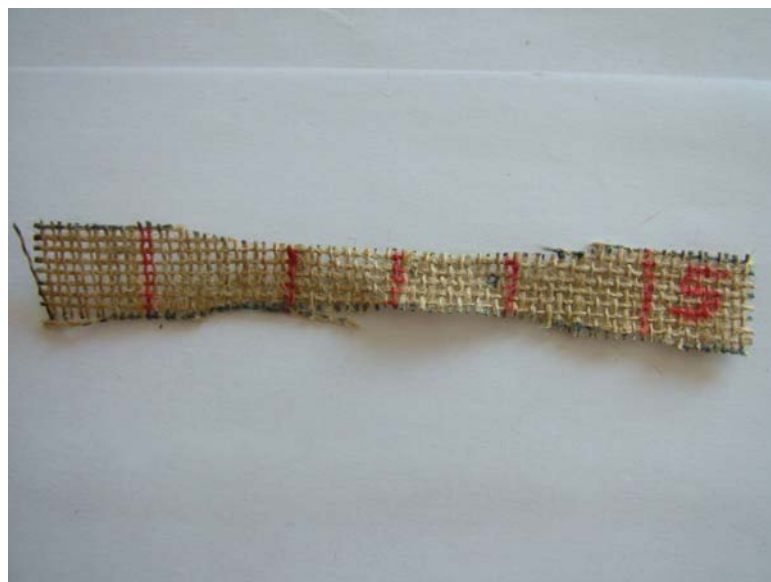
FIGURA 85 – Corpo de prova n° 5 com tecido de juta com fios da trama a 90°: fios paralelos à solicitação dos esforços, atuam como reforço e os transversais, não.
