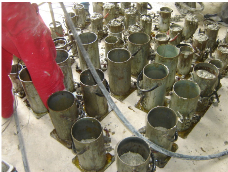
Figura 63 - Moldagem dos corpos de prova
