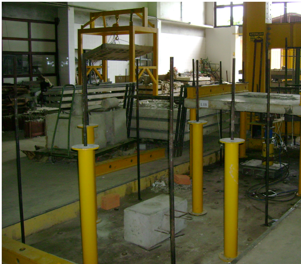
Figura 74 - Tirantes fixados à laje de reação e perfis metálicos envolvendo os tirantes
