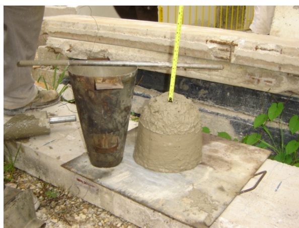
Figura 70 - Ensaio de abatimento do tronco de cone (Slump Test)
