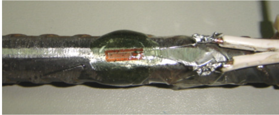
Figura 56 - Detalhe do posicionamento do extensômetro na barra
