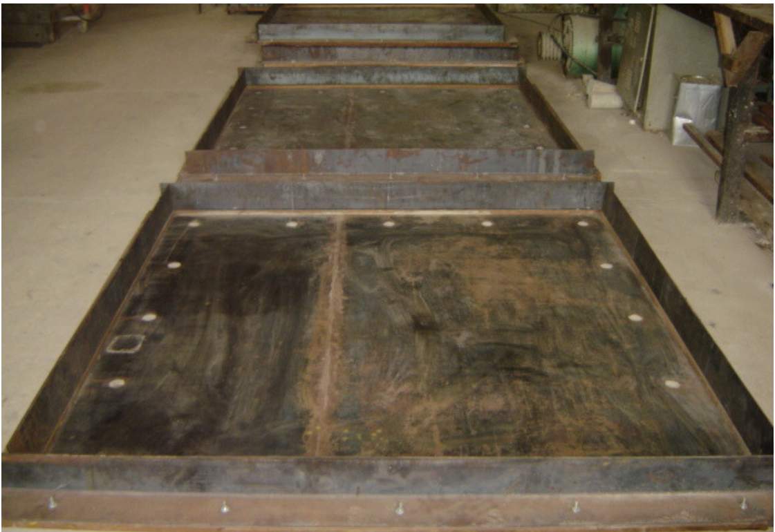
Figura 65 - Formas metálicas utilizadas na confecção das lajes
