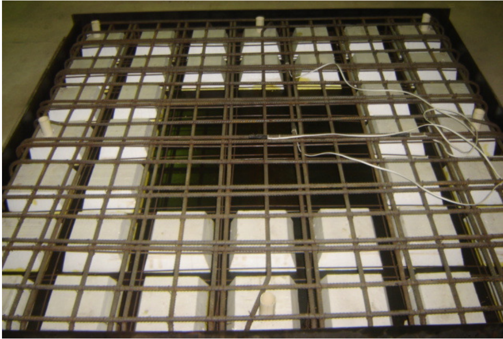
Figura 37 - Posicionamento das armaduras da laje L1 na forma
