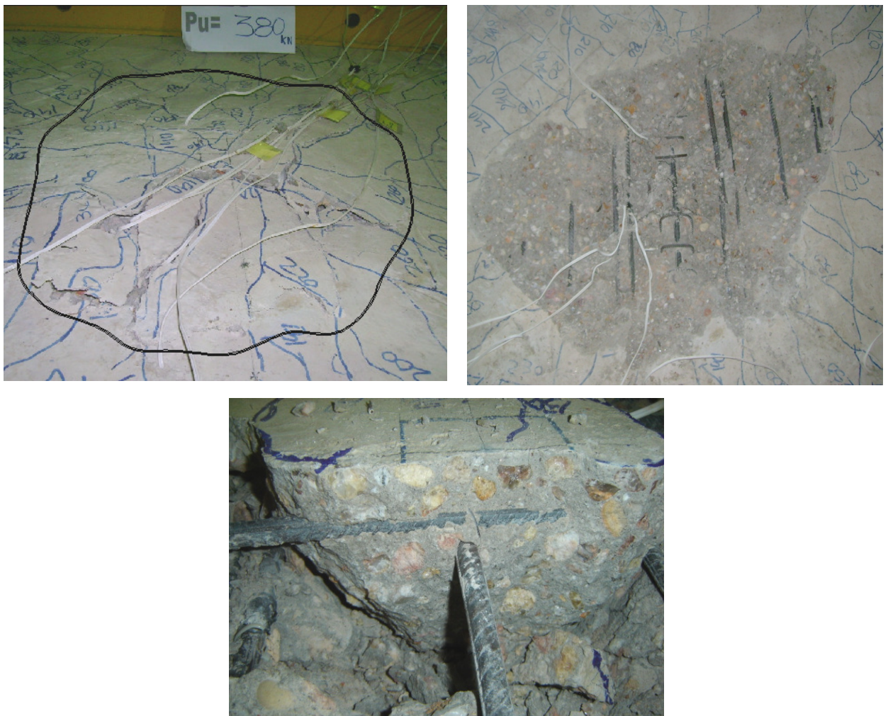
Figura 138 - Determinação da inclinação da superfície de ruptura
