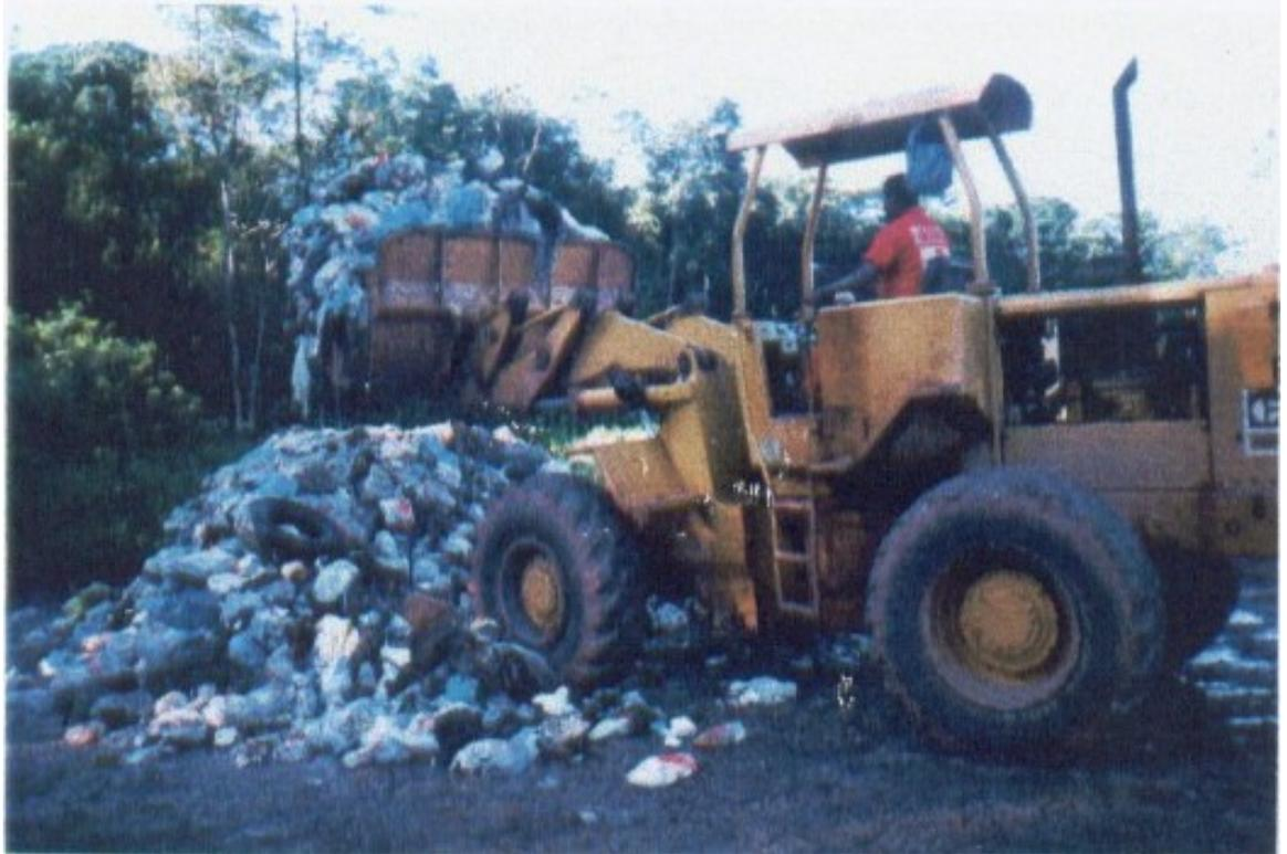
Fotografia 15 – Retirada da amostra de 1m<sup>3</sup>.
