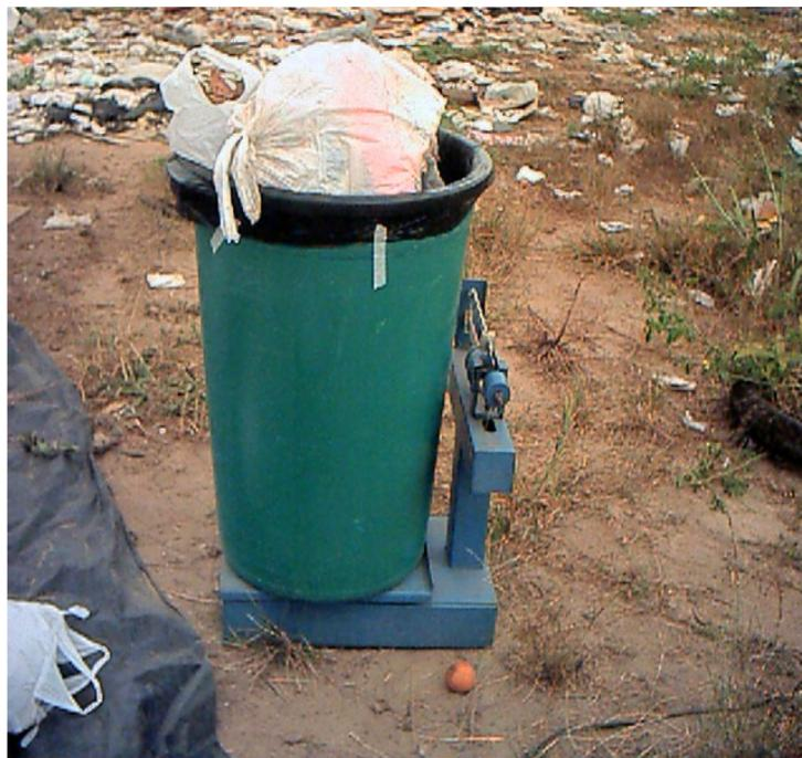
Fotografia 18 – Processo de pesagem da amostra de RSD.
