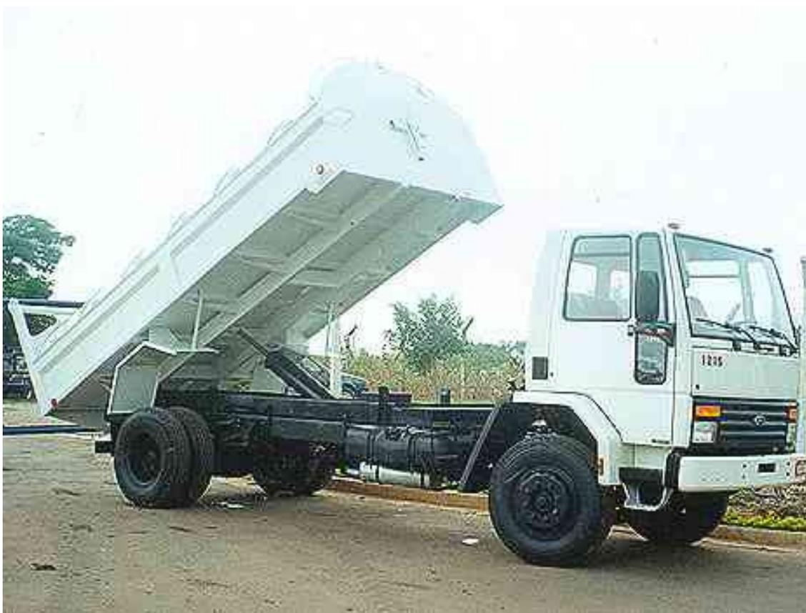
Fotografia 8 – Veículo coletor sem compactação.
