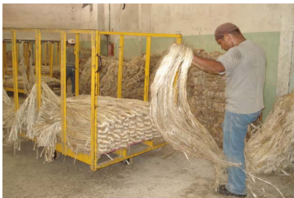
Fotografia 16 - As fibras sendo retorcidas e acondicionadas em carros transportadores
