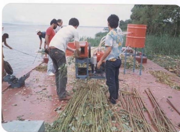
Fotografia 10 - Os técnicos do Ifibram fazendo teste com malva, em um modelo de descortecedor. Manacapuru (AM)
