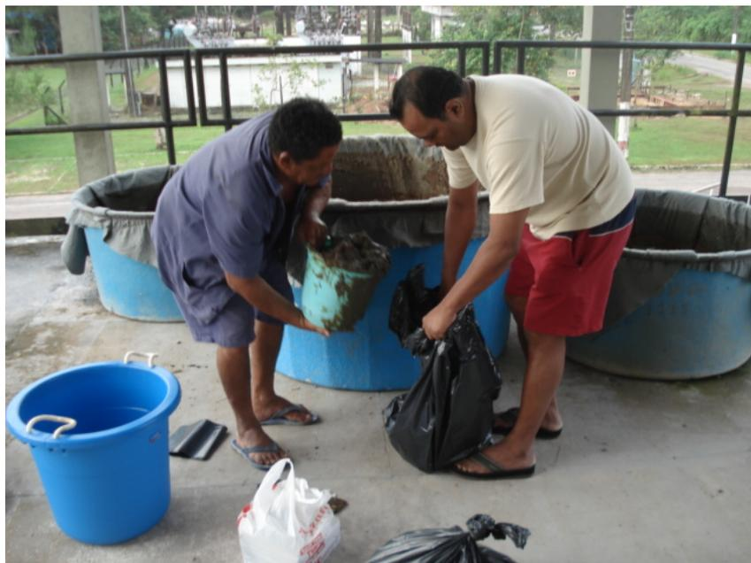
**Figura 4.28:** Colocação do lodo desaguado em sacos plásticos para transporte à indústria cerâmica após as fases de drenagem e secagem na UDL2.
