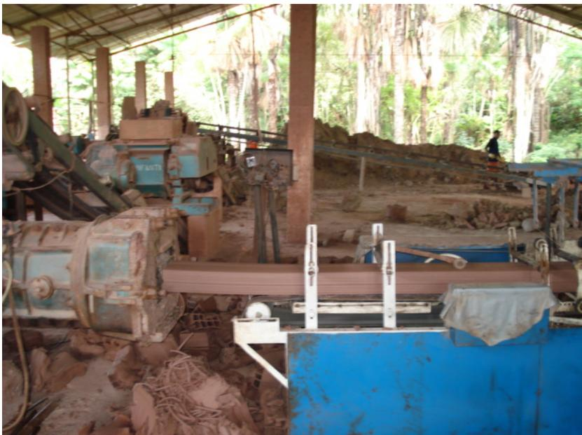
**Figura 4.8:** Processo de extrusão
