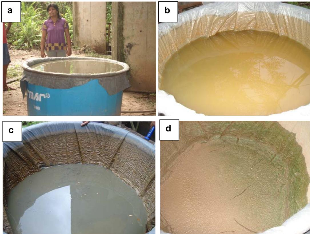
**Figura 4.23:** Monitoramento do lodo contido na UDL1 onde observam-se nas figuras a) lodo após o lançamento; b) lodo com 02 dias de secagem; c) lodo com 07 dias e d) lodo com 10 dias.
