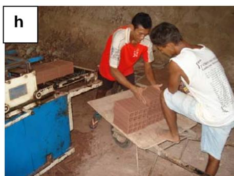
**Figura 4.31:** Processo de fabricação dos tijolos cerâmicos com lodo da ETA Bolonha; a) lodo no pátio da indústria cerâmica; b) massa cerâmica (0% de lodo); c) mistura lodo/argila; d) lançamento da mistura (esteira); e) homogeneizador; f) extrusora; g) vagonetes transportadores; h) transporte dos tijolos.
