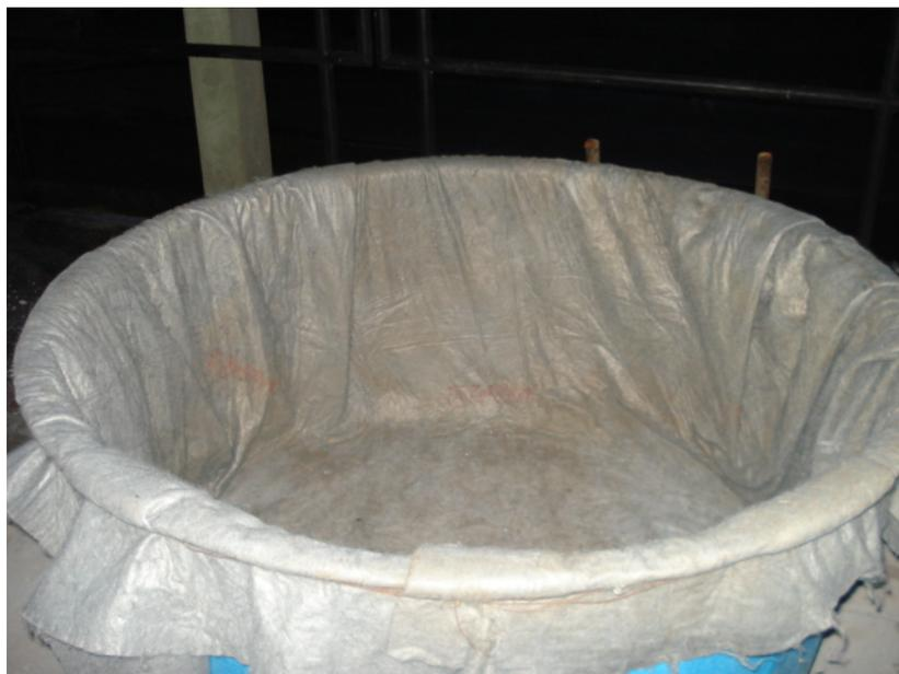
**Figura 4.24:** Manta Geotextil limpa e preparada para utilização em novos ensaios.
