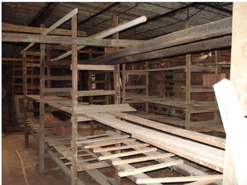
**Figura 4.10:** Estufa para secagem dos tijolos moldados.
