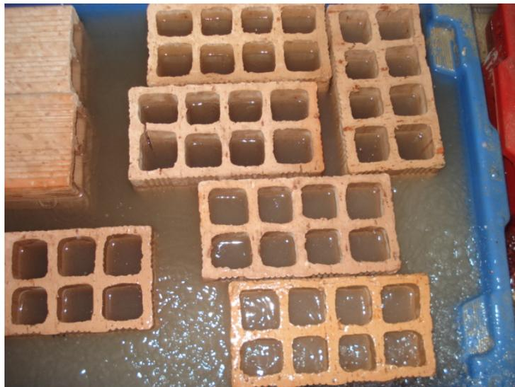
**Figura 4.38:** Tijolos imersos em tanque com água
