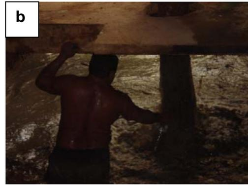
**Figura 4.21:** a) operador coletando lodo na válvula de fundo do decantador nº 04 e b) coleta de amostras do lodo para análise química.
