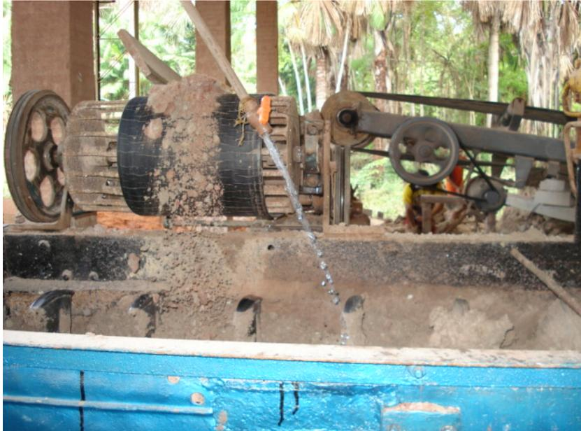
**Figura 4.7:** Processo de mistura da massa cerâmica (argila magra e gorda)
