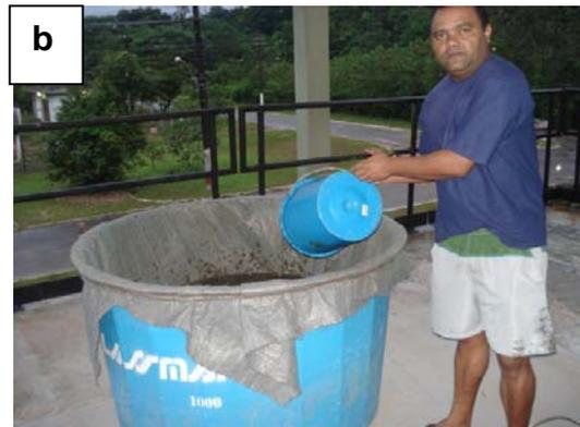
**Figura 4.26:** a) Transporte das amostras de lodo e b) Lançamento das amostras de lodo em um dos reservatórios da UDL2.
