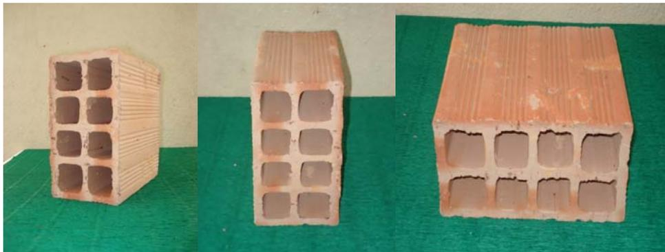
**Figura 4.30:** Tijolo-testemunho (0% de lodo).
