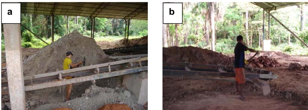
**Figura 4.6:** Processo de colocação de argilas nas esteiras (operação manual); a) argila gorda (plástica); b) argila magra (argilão).
