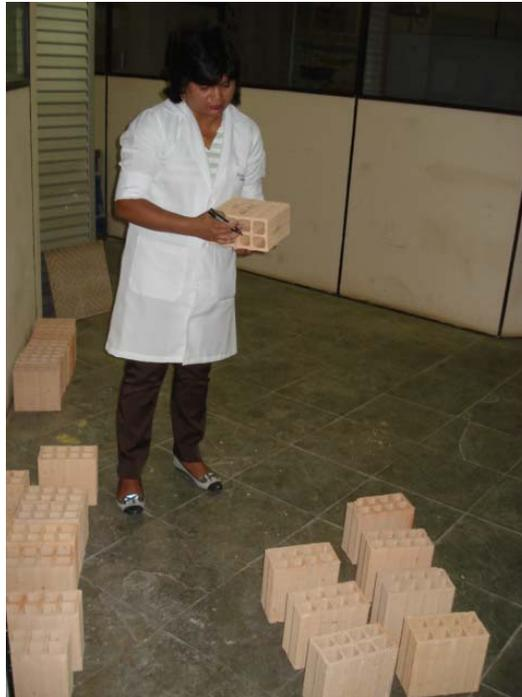
**Figura 4.36:** Separação e identificação dos tijolos cerâmico para amostragem .
