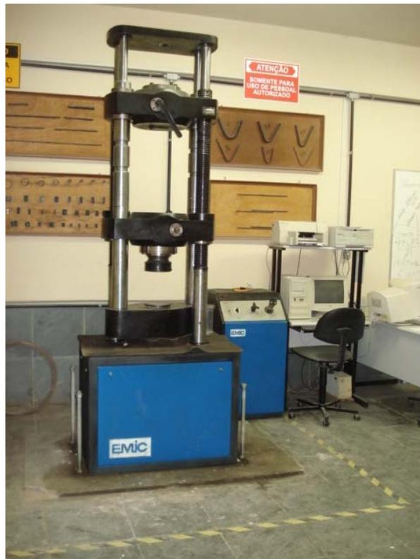
**Figura 4.35:** Prensa Hidráulica usada para a realização do ensaio de resistência à compressão.
