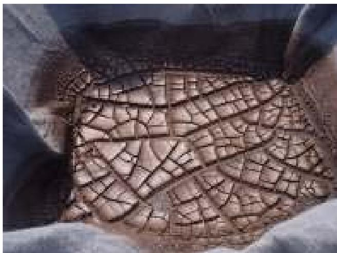
**Figura 3.3:** Massa de lodo retida no leito de drenagem empregando uma Manta Geotextil
