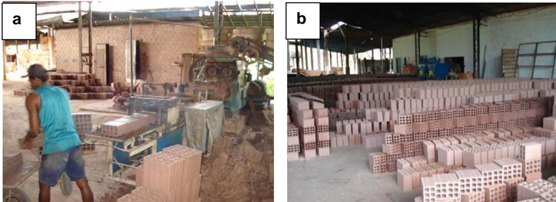
**Figura 4.9:** Processo de transporte e secagem dos tijolos cerâmicos; a) transporte dos tijolos; b) setor de secagem
