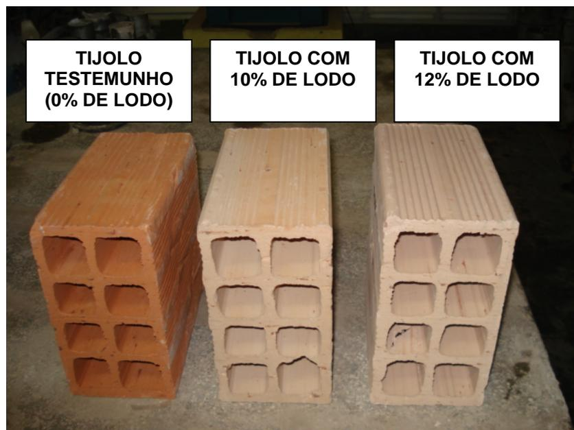
**Figura 4.33:** Aspecto visual da coloração dos tijolos cerâmicos utilizados no ensaio de resistência à compressão
