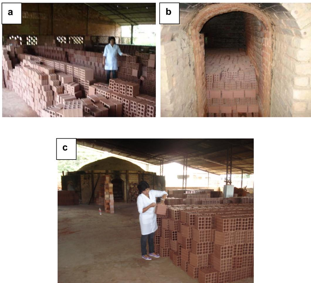
**Figura 4.32:** Continuação do processo de fabricação dos tijolos cerâmicos com lodo da ETA Bolonha; a) setor de secagem; b) queima dos tijolos; c) seleção e expedição
