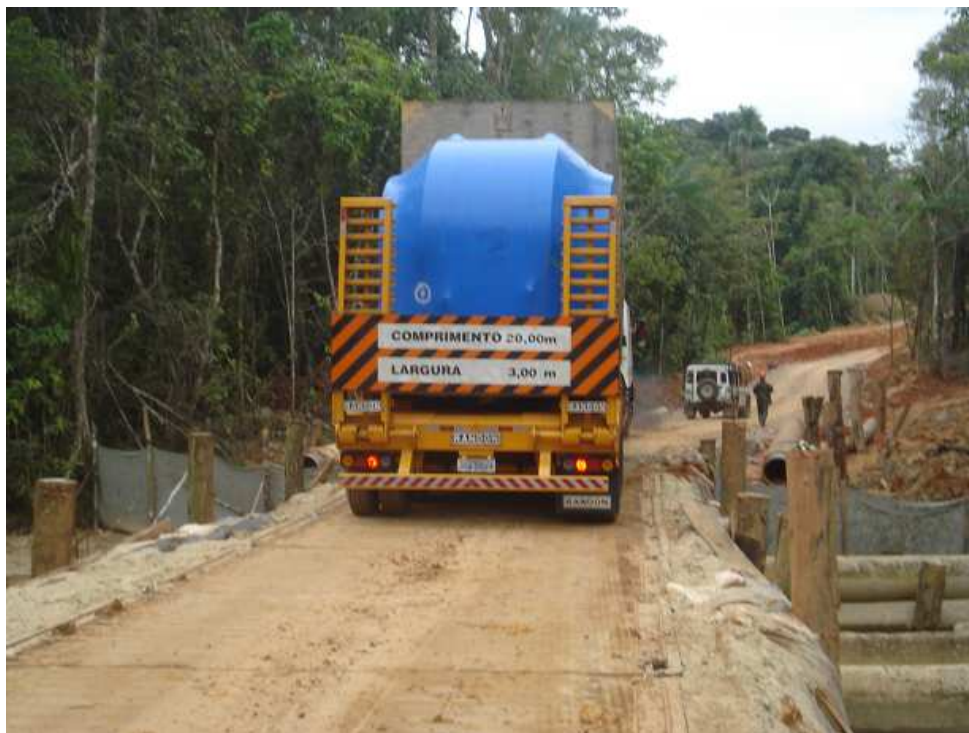
Passagem de carreta com compressor e turbina com 49 toneladas sobre a Ponte do Igarapé do Cedro.
