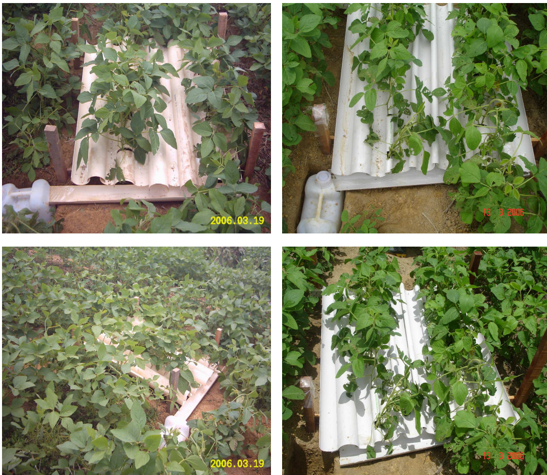
Figura 14: Sistema de calhas utilizado para a medida da interceptação de água na plantação de soja
