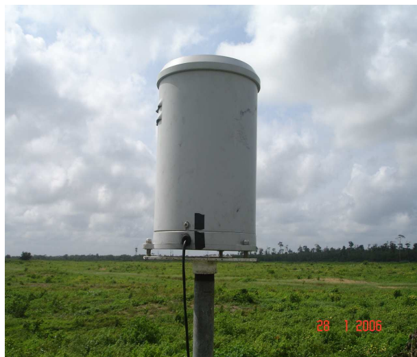
Figura 13: Pluviômetro instalado na EMA, localizada na plantação de soja (Paragominas-PA).
