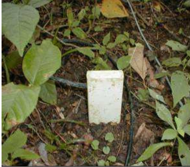
Figura 16: Sensor de umidade do solo (TDR), instalado na plantação de soja.
