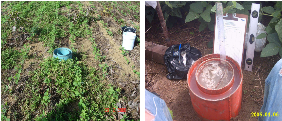
Figura 12: Infiltrômetro de anel utilizado para a medida da infiltração de água na plantação de soja em Paragominas-PA.
