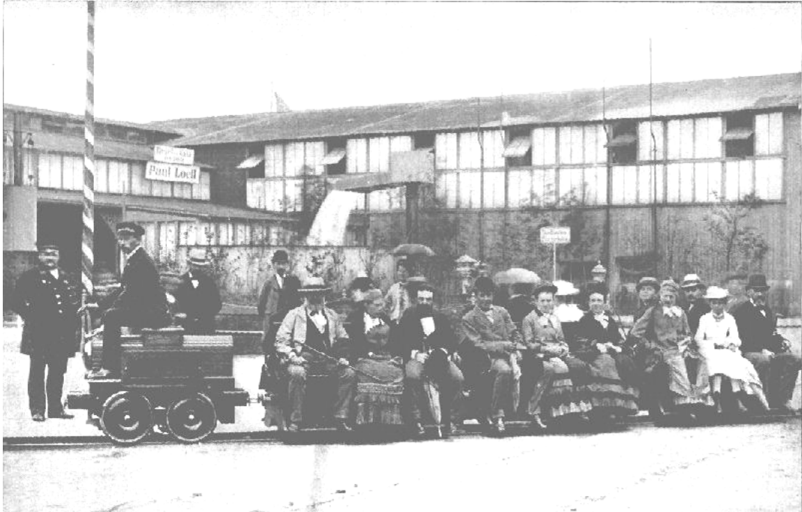
Fotografia 4 – Locomotiva elétrica de Siemens & Halske na Exposição Comercial de Berlim em 1879. A pequena locomotiva de 3HP transportando passageiros ao longo dos 300 metros da linha circular.
