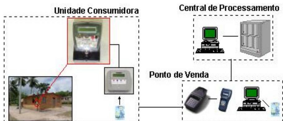
Figura 3.45 – Esquema do sistema pré-pago.
