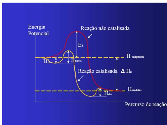
Figura 3.18: Comparação da reação catalisada com a não catalisada - variação da energia potencial com o decorrer da reação
