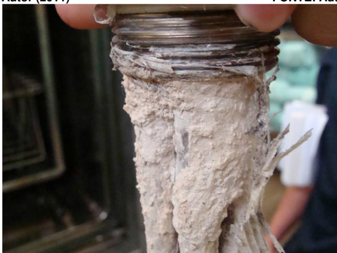
Figura 5.26 - Incrustação do aquecedor de água da autoclave
