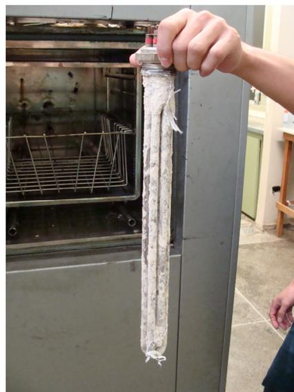
Figura 5.25 - Incrustação do aquecedor de
