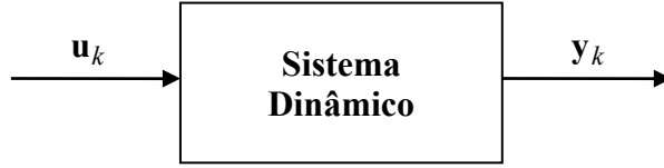
Figura 3-3 – Sistema dinâmico com entradas, saídas determinísticas no tempo discreto
