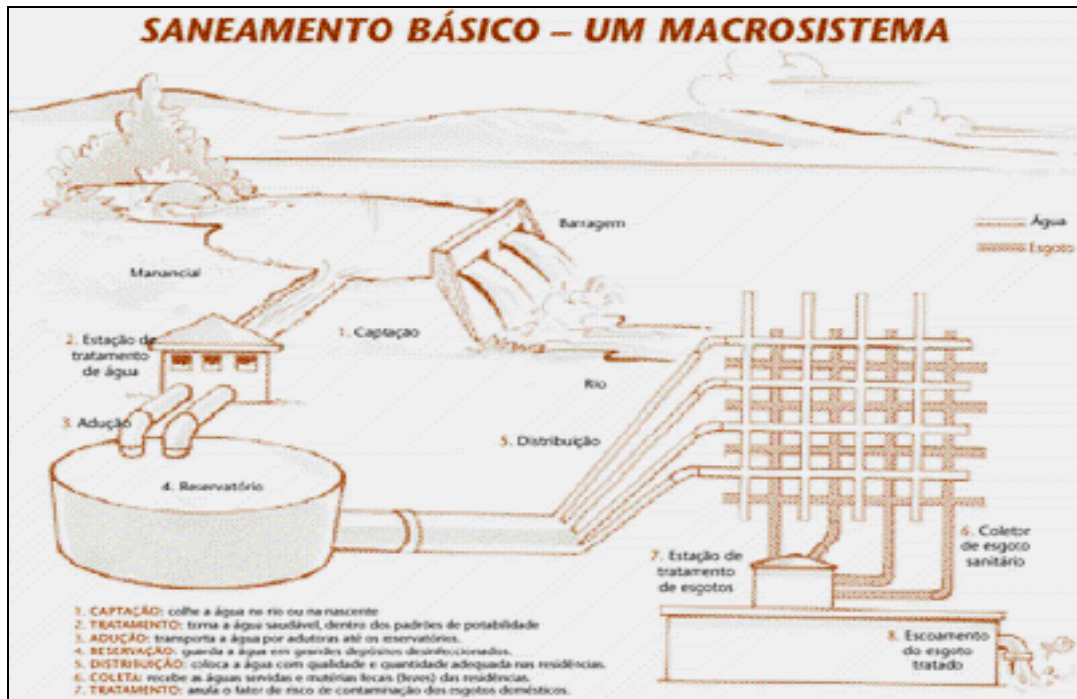
Figura 3.1: Sistemas de abastecimento de água e de esgotamento sanitário no ciclo de uso da água no meio ambiente urbano.
