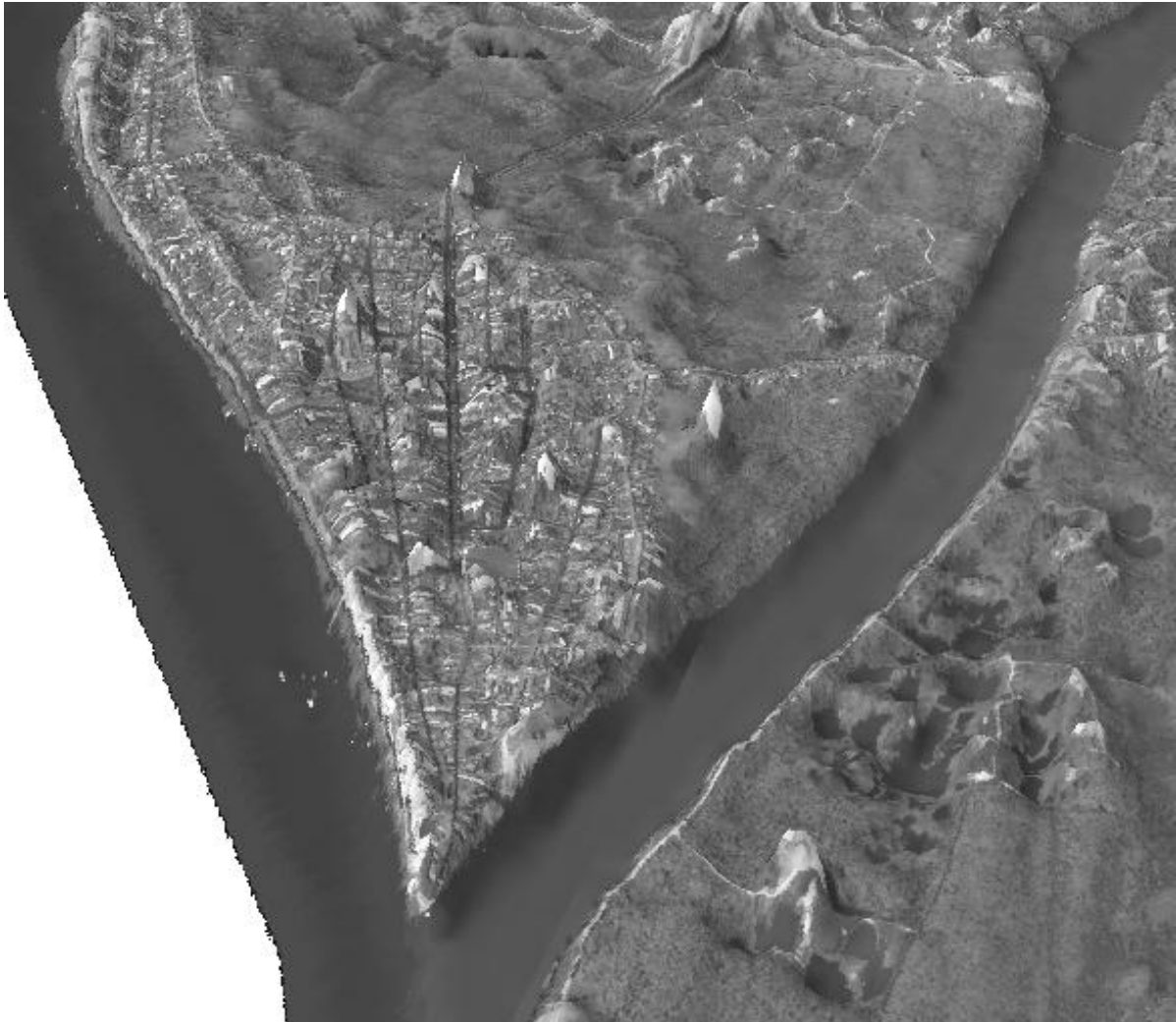
Figura 35 - Modelo Digital do Terreno do tipo superfície utilizando a imagem de satélite para o modelo 3D, com exagero vertical acentuado.
