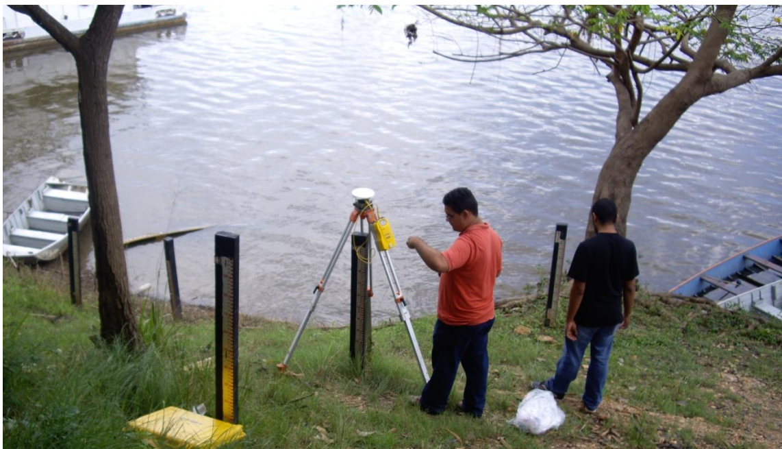
Fotografia 5 - Conjuntos de réguas utilizadas para medir as mudanças do nível do rio Tocantins em Marabá-Pa. (Fonte: Jamer Costa)
