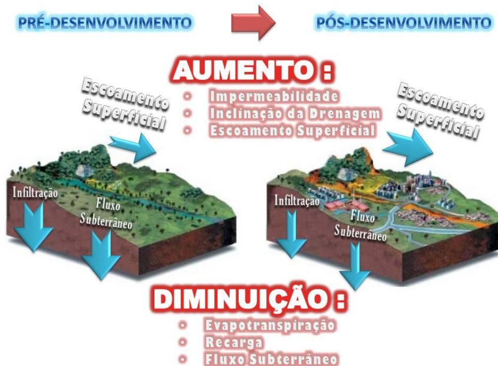
Figura 4 - Mudanças com o desenvolvimento e suas relações com o fluxo hidrológico (Fonte: modificada de PINTO e PINHEIRO, 2006).
