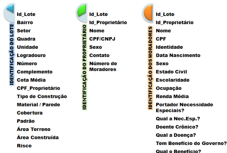
Figura 58 - Sugestão das Informações mínimas necessárias sobre cada um dos lotes e das famílias para o Sistema de Alerta de Enchente.
