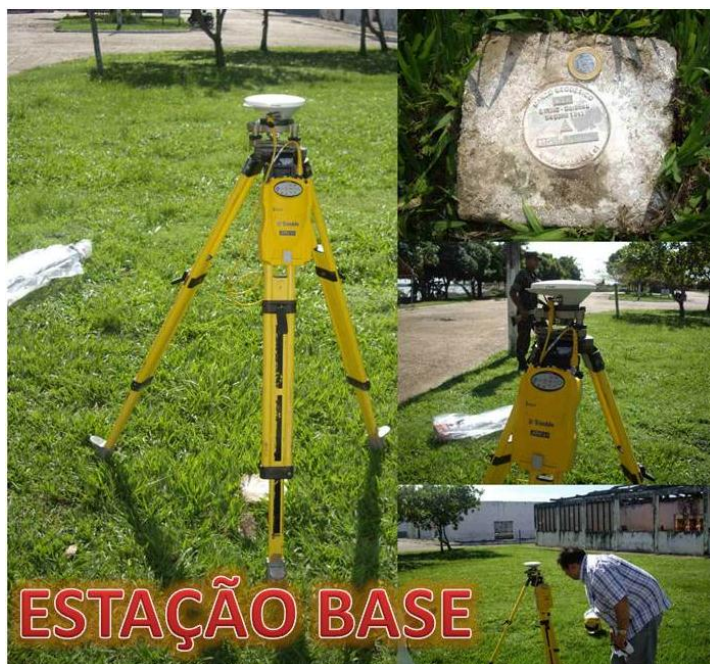
Fotografia 7 - Ponto da estação base de coletas de dados DGPS - Quartel da Marinha do Brasil
