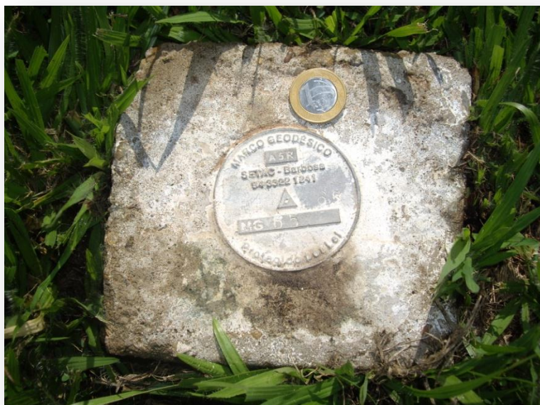
Fotografia 6 - Marco geodésico MG85 (ASR) utilizado com estação base para os levantamentos de campo.
