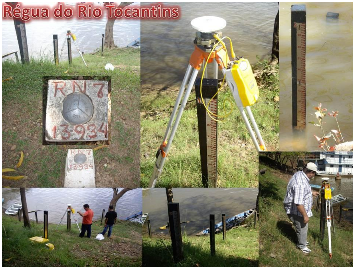
Fotografia 8 - Réguas de monitoramento do nível do Rio Tocantins.
