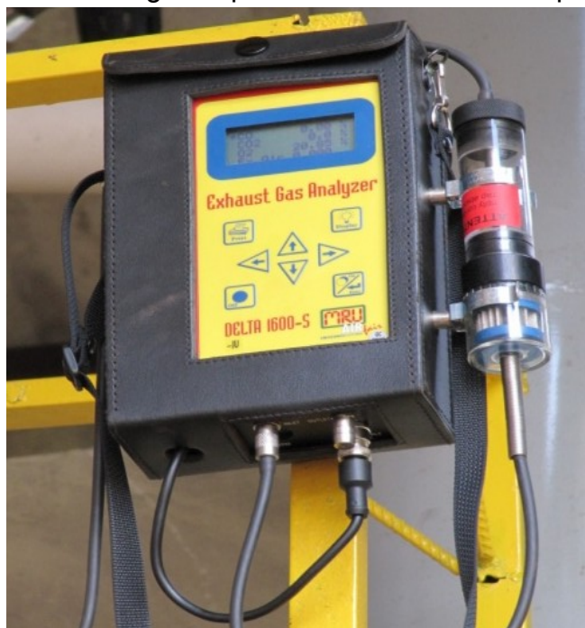
Figura 3.8 – Analisador de gases por infravermelho não dispersivo MRU Delta.
