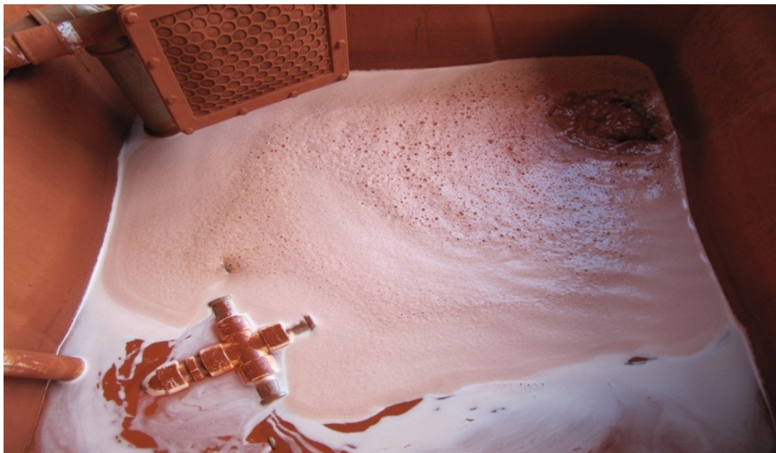
Figura 3.24 - Captador em operação trabalhando em baixa turbulência.
