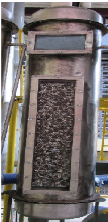
Figuras 3.6 - Torre de recheio preenchida com selas.
