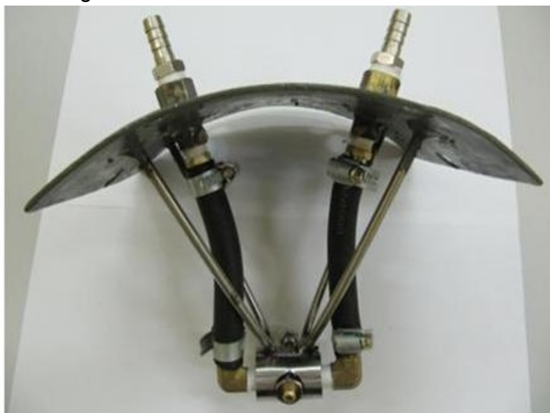
Figura 3.13 - Bico gerador de névoa montado com as conexões de ar e água.
