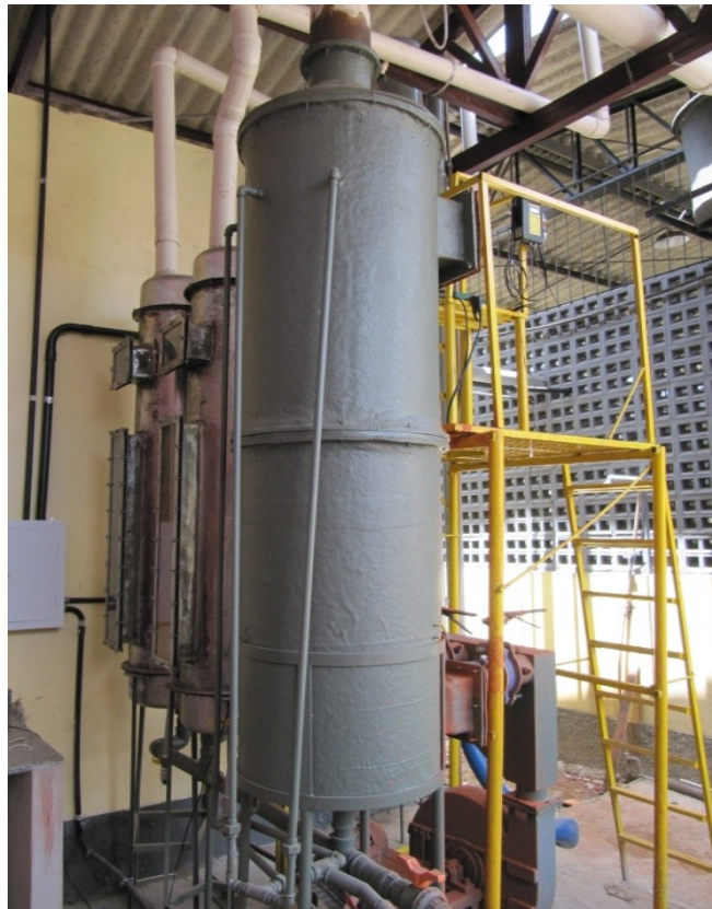
Figura 3.3 - Torre de aspersão com dez bicos centrífugos em dois níveis.
