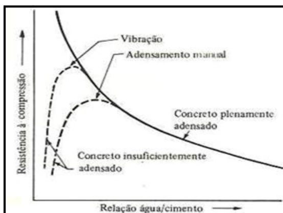
Figura 2.6 - Resistência do concreto e a relação água-cimento. Fonte: NEVILLE (1997).
