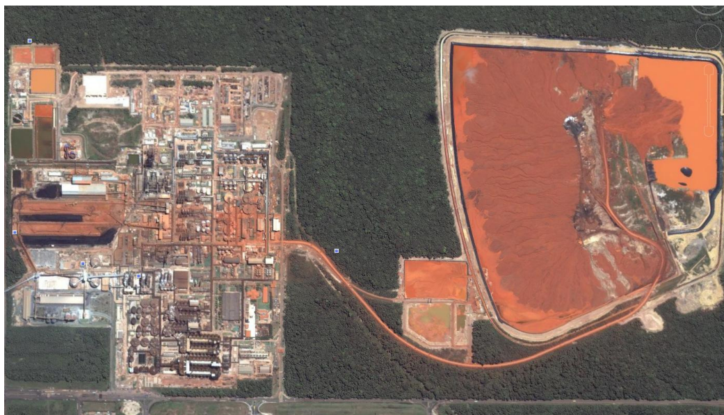
Figura 1.1 - Foto aérea da fábrica da ALUNORTE em Barcarena, PA destacando o depósito de rejeitos sólidos (DRS) onde é estocada a lama vermelha proveniente do processo Bayer. Fonte: SOUZA et al. (2006).
