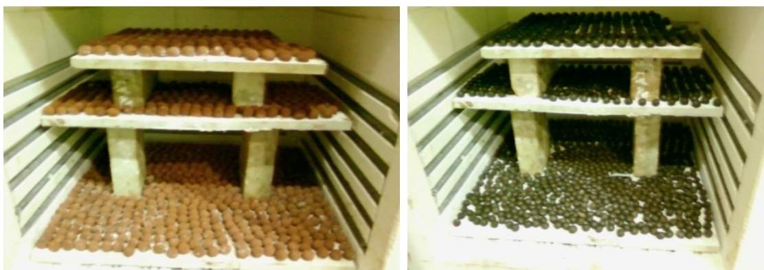
Figura 5.2 - Agregados antes da queima (à esquerda) e após a queima a 1200°C (à direita).
