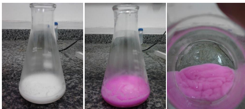
Figura 5.35: Formação excessiva de emulsão.
