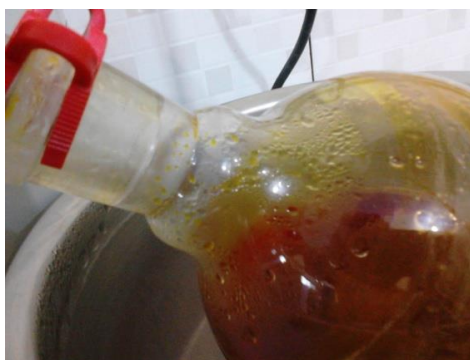
Figura 5.15: Condensação da água antes de atingir o estágio de troca térmica.
