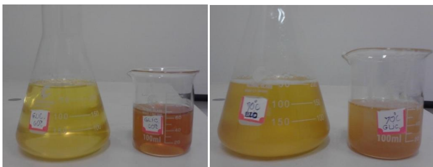
Figura 5.30: Turbidez da FRES a 60°C em relação a de 70°C.
