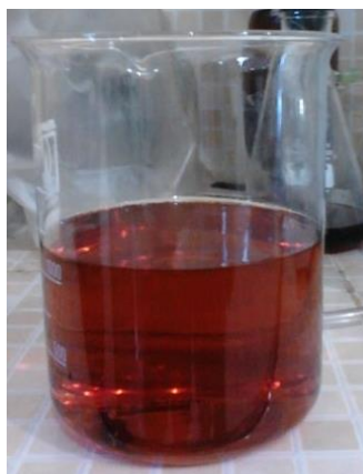
Figura 5.19: Produto da Reação de Transesterificação.
