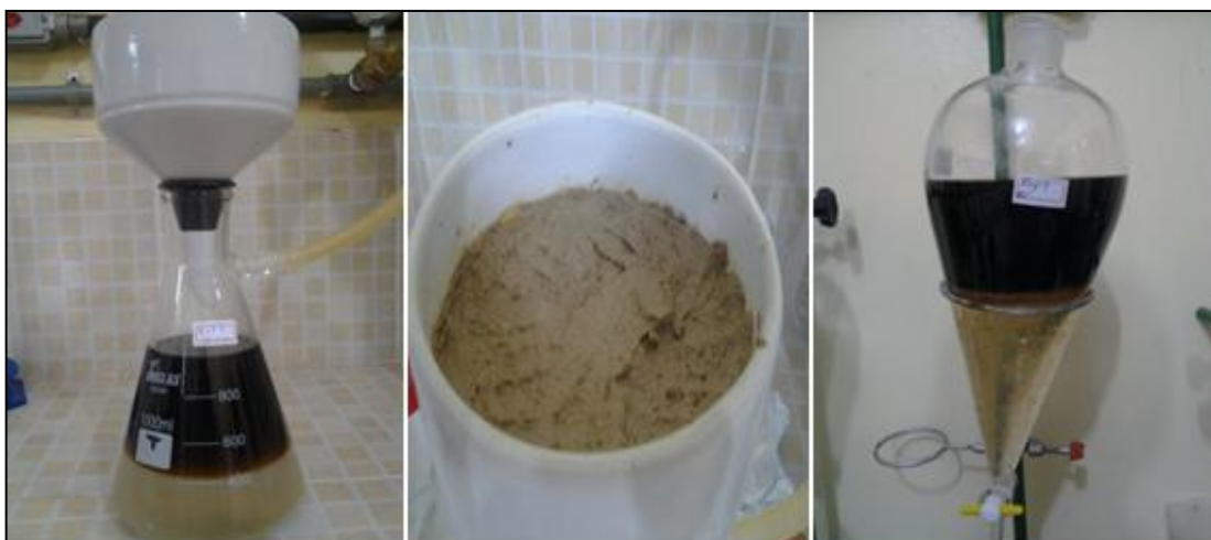
Fig.4.6 – Filtração, resíduo sólido e decantação dos produtos líquidos coletados.
