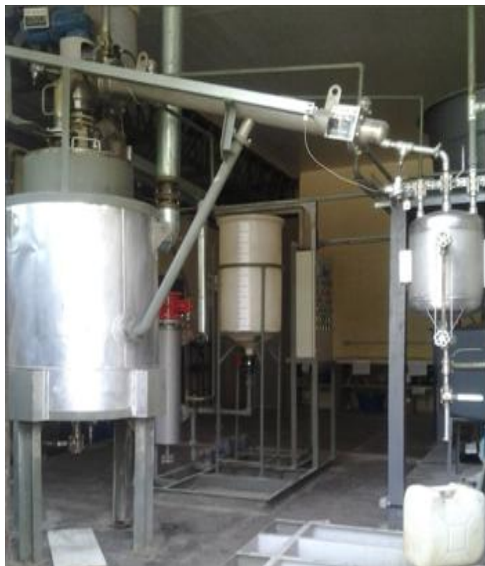
Fig.4.5 – Esquema de condensação e coleta de produtos
