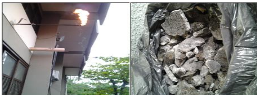
Fig.5.5 – Flair e resíduo formado durante o craqueamento
