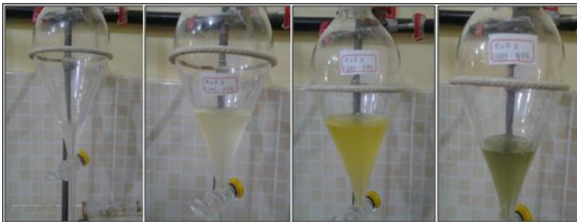
Fig.5.13 – Frações destiladas na faixa (40-175°C), (175- 35°C), (235-305°C) e (305-400°C).
