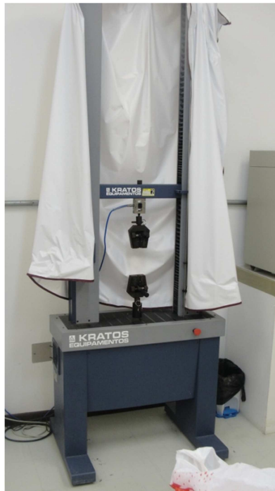
Figura 25 - Máquina de ensaio universal KRATOS, do laboratório de materiais dentários do Centro de Especialidades Odontológicas da Faculdade de Odontologia da Universidade Federal do Pará (UFPA).
