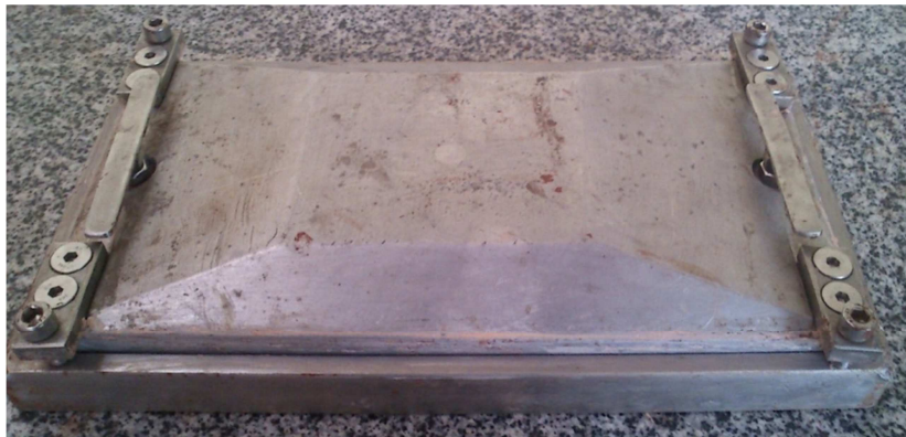
Figura 23 - Molde metálico com sistema de parafusos Allen para produção das placas de compósitos.
