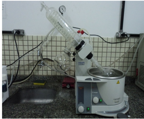
Fotografia 5: Destilação do mosto fermentado
